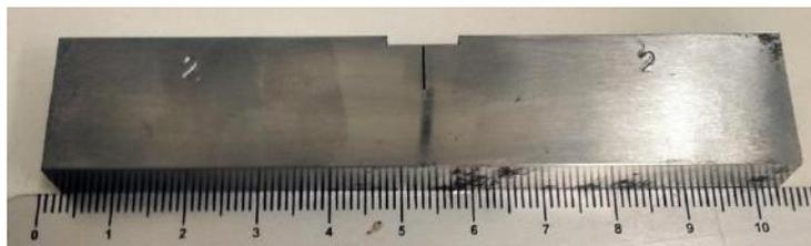
Figura 41 - Corpo de prova de flexão SE(B) usinado, entalhado e pronto para ser testado.
