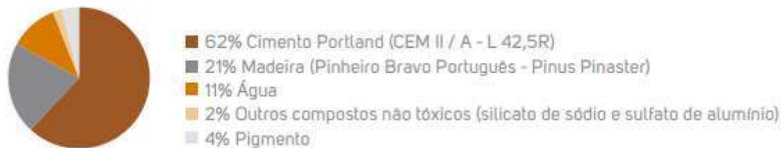
Figura 17 - Composição do Viroc® (Fonte: Dossiê Técnico Viroc®)
