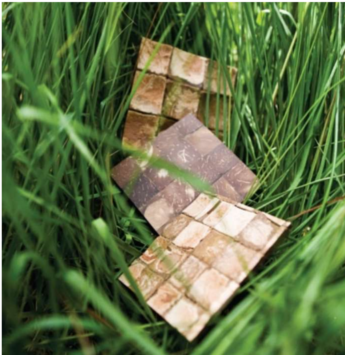
Figura 5 - Ekobe, revestimento feito com casca de coco. (LEFTERI, 2007. Ingredients: A Materials Project, segunda edição)
