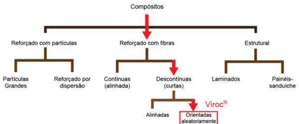
Figura 6 - Tipos de compósitos de acordo com a organização de suas fases dispersas e classificação do Viroc®. (Adaptado de Callister e Rethwisch, 2012)
