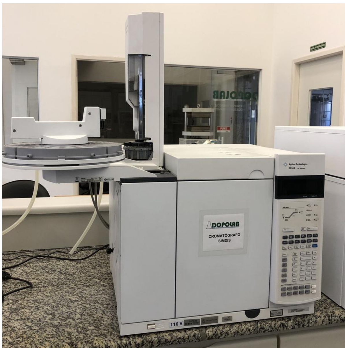
Figura 11 – Unidade de Cromatografia Gasosa similar a utilizada na análise, localizada no DOPOLAB.
