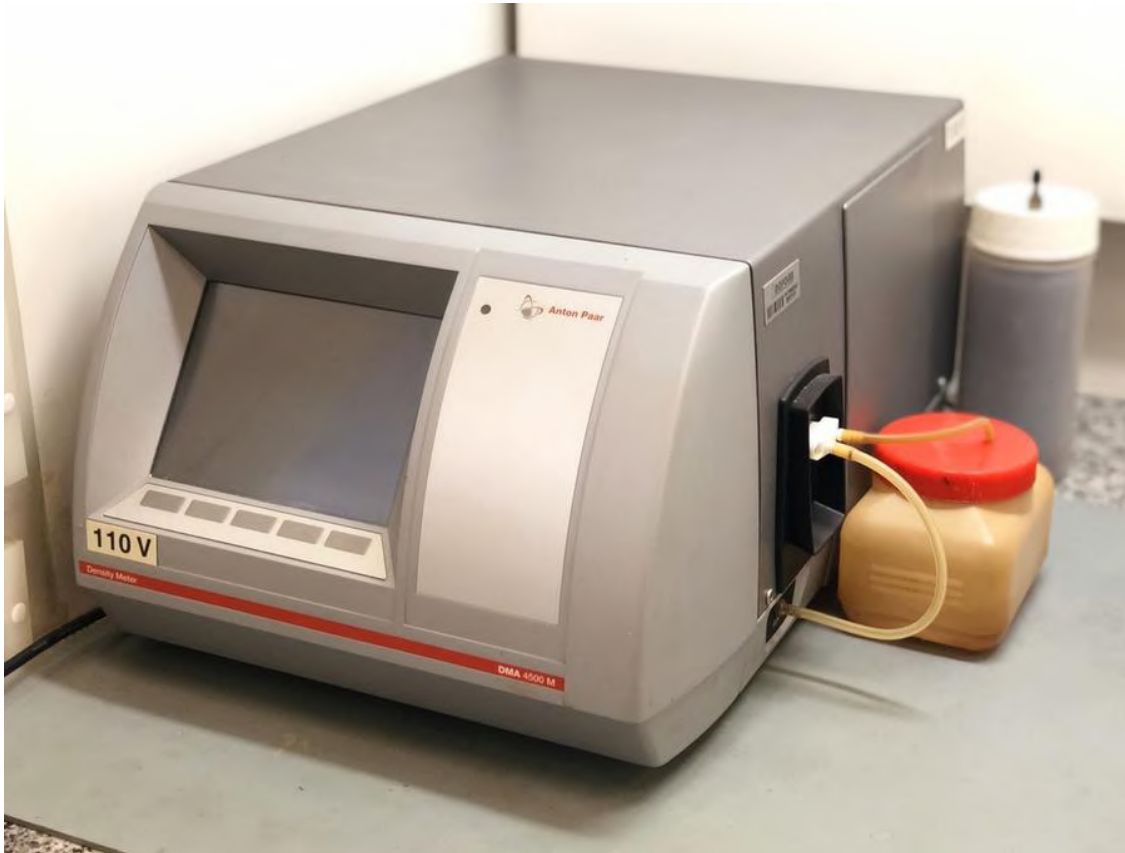
Figura 10 – Densímetro digital utilizado para aferição de densidade das frações destiladas, localizado no DOPOLAB.
