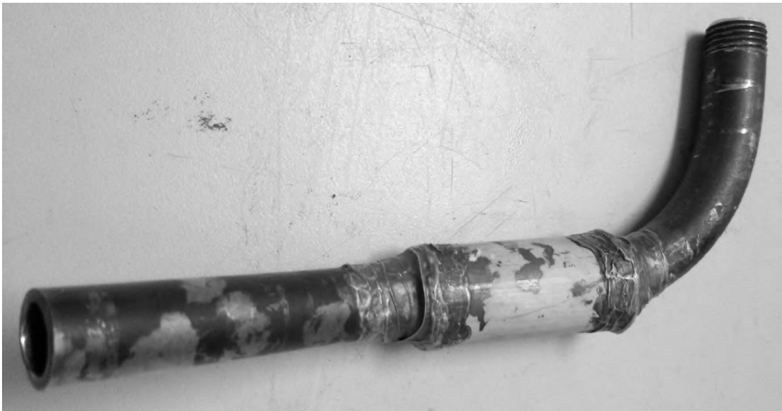
Figura 29 - Tubulação de entrada do combustível no empilhamento.
