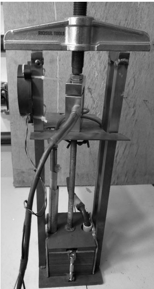
Figura 57 - Montagem: mica de proteção (A); êmbolo de compressão e coletor de corrente positivo (B); sistema de compressão (C); caixa do empilhamento (D).
