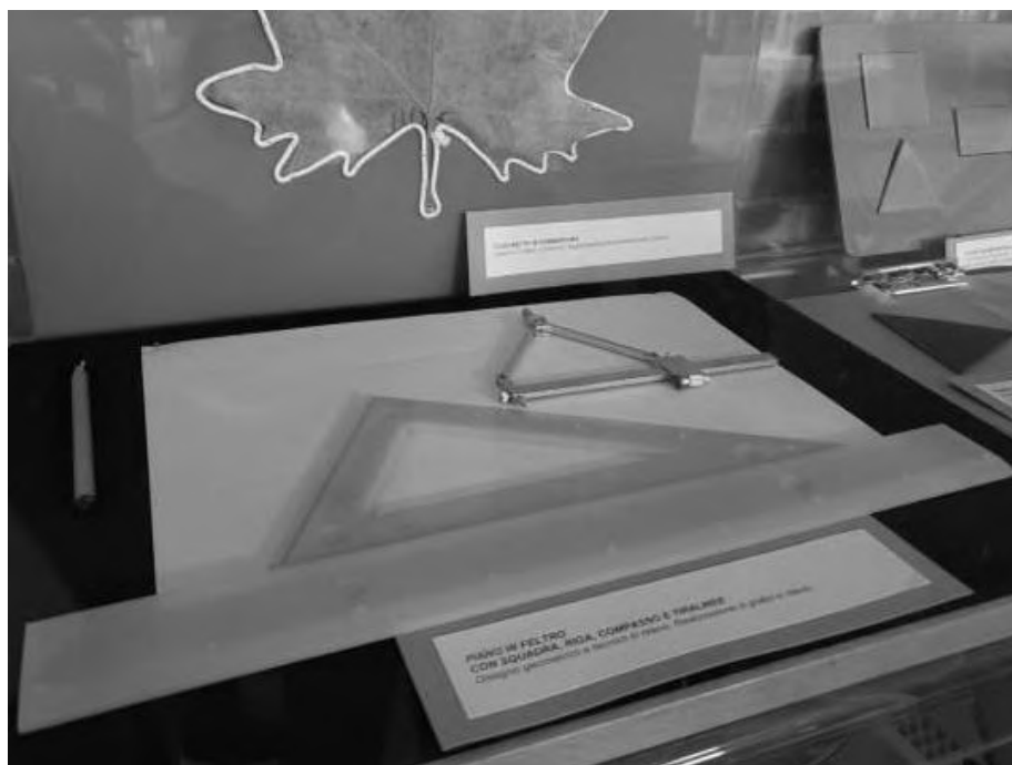
Figura 6- Instrumentos de Desenho adaptado para o uso de deficientes visuais ( Biblioteca Italiana per I Ciechi – Centri di consulenza Tiflodidattica ; Foto: Cerqueira, 2019).
