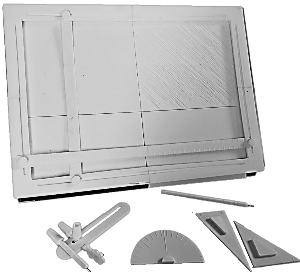
Figura 85- Conjunto de Instrumentos produzidos em impressão 3D. (Fonte: Elaboração própria, 2019).
