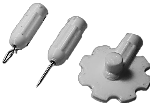
Figura 74- Traçadores impressão 3D (Fonte: Elaboração própria, 2019).
