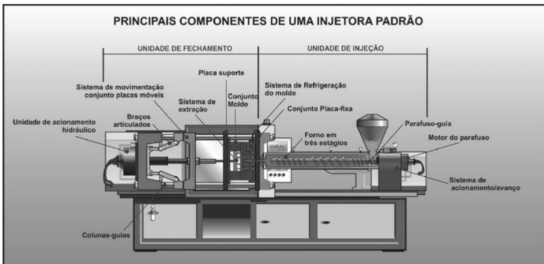
Figura 23 Estrutura mecânica de uma injetora padrão. (Fonte: Cerqueira, 2010)
