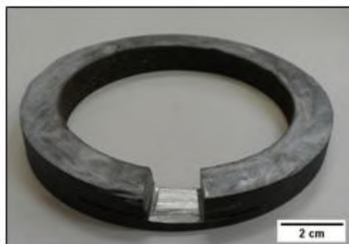
Figura 3. 2: Anel de onde foram retiradas as amostras para caracterização.
