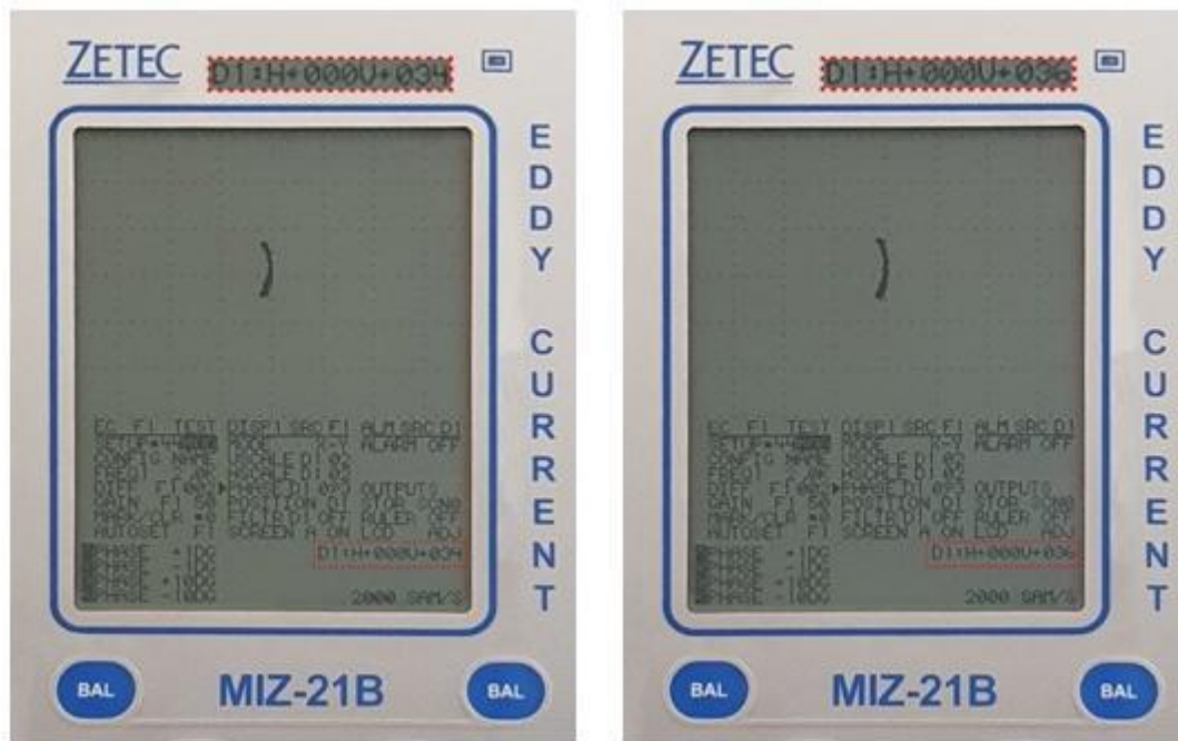
Figura A. 2: (a) Resultado do ensaio com a calibração proposta para o entalhe oito E8, e (b) Resultado do ensaio com a calibração proposta para região fora do entalhe.
