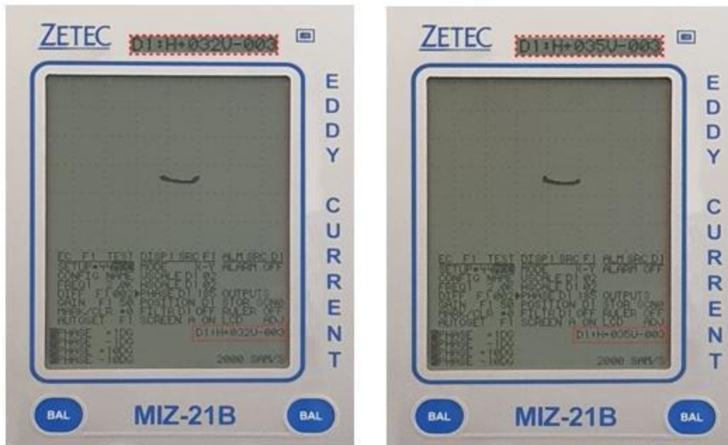
Figura A. 1: (a) Resultado do ensaio com a calibração na horizontal para o entalhe oito E8, e (b) Resultado do ensaio com a calibração na horizontal para região fora do entalhe.
