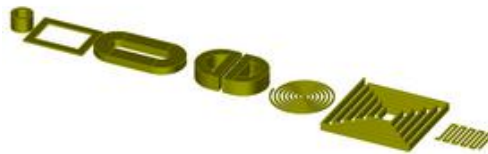
Figura 2. 17: Diferentes tamanhos de sondas de correntes parasitas (EXTENDE, 2017).
