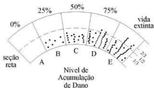
Figura 2. 7: Critério de avaliação de dano acumulado por fluência em tubos de reforma. Adaptado de (SILVEIRA, 2006).
