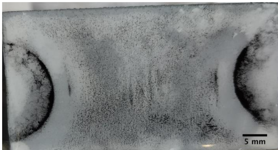
Figura 75. Revelação por PM da amostra veículo B_1.3. Profundidade de 670 \mu\text{m} , 470 \mu\text{m} abaixo da cavidade.
