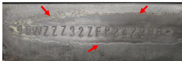
Figura 11. Exemplo de chassi implantado, presença de marcas de solda. Fonte: Google.com
