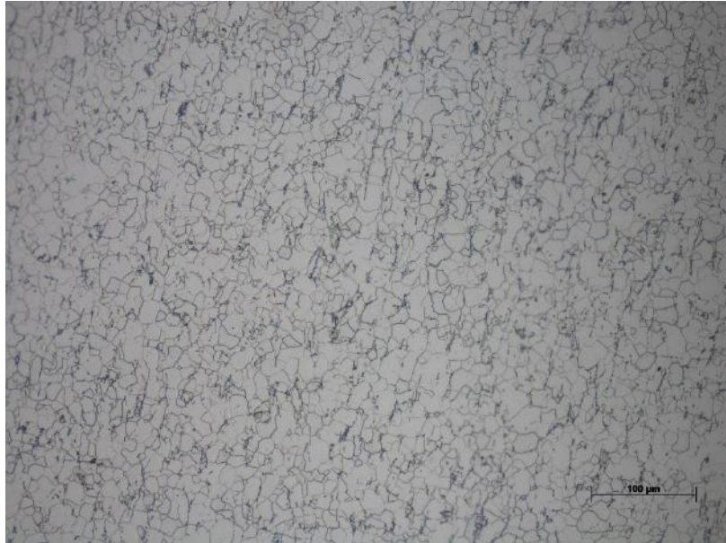
Figura 37. Micrografia longitudinal da amostra veículo BC_1. Aumento: 200x.
