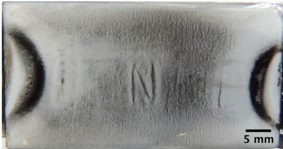
Figura 74. Revelação por PM da amostra veículo B_1.2. Profundidade de 460 \mu\text{m} , 260 \mu\text{m} abaixo da cavidade.
