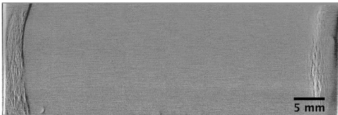
Figura 72. Magnetograma da amostra veículo B_1.4. Profundidade de 870 \mu\text{m} , 670 \mu\text{m} abaixo da cavidade.
