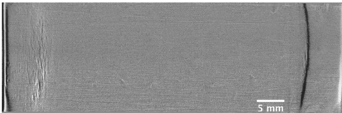
Figura 71. Magnetograma da amostra veículo B_1.3. Profundidade de 670 \mu\text{m} , 470 \mu\text{m} abaixo da cavidade.
