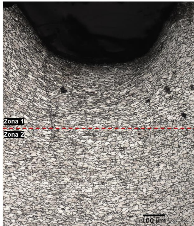
Figura 15. Micrografia óptica de um aço baixo carbono, após estampagem, 10x. Observa-se a mudança de forma dos grãos, zona 1, evidenciando a zona de deformação plástica, e a dispersão da deformação ao longo da zona 2, região não-deformada.
