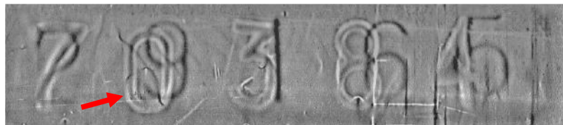
Figura 10. Exemplo de uma adulteração por recobrimento total com estanho seguido de regravação.
