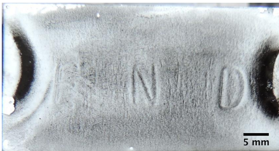
Figura 73. Revelação por PM amostra veículo B_1. Profundidade de 290 \mu\text{m} , 90 \mu\text{m} abaixo da cavidade.
