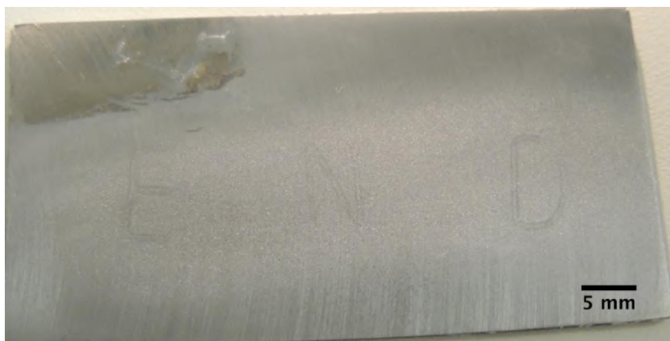
Figura 78. Revelação por ataque eletrolítico da amostra veículo B_1.2. Profundidade de 460 \mu\text{m} , 260 \mu\text{m} abaixo da cavidade.
