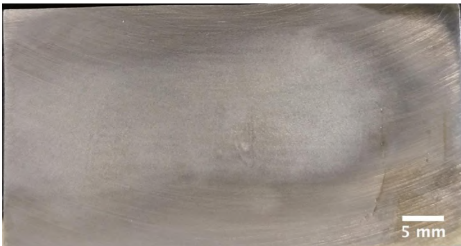
Figura 80. Revelação por ataque eletrolítico da amostra veículo B_1.4. Profundidade de 870 \mu\text{m} , 670 \mu\text{m} abaixo da cavidade.
