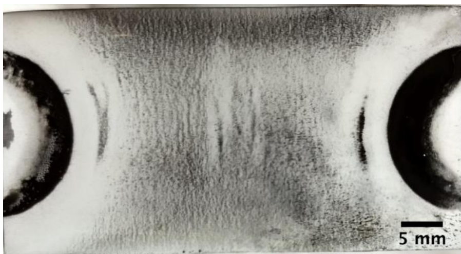
Figura 76. Revelação por PM da amostra veículo B_1.4. Profundidade de 870 \mu\text{m} , 670 \mu\text{m} abaixo da cavidade.
