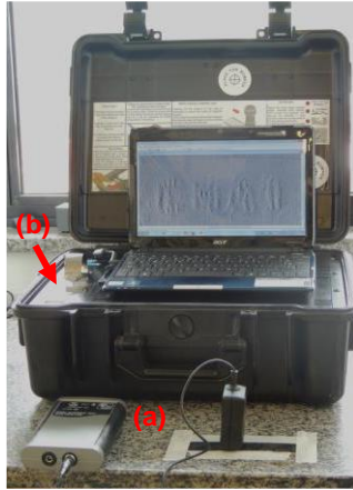
Figura 29. Ilustração do equipamento. (a) Indutor de correntes parasitas (Regula 7515); (b) Leitor Magneto-Óptico (Regula 7505).
