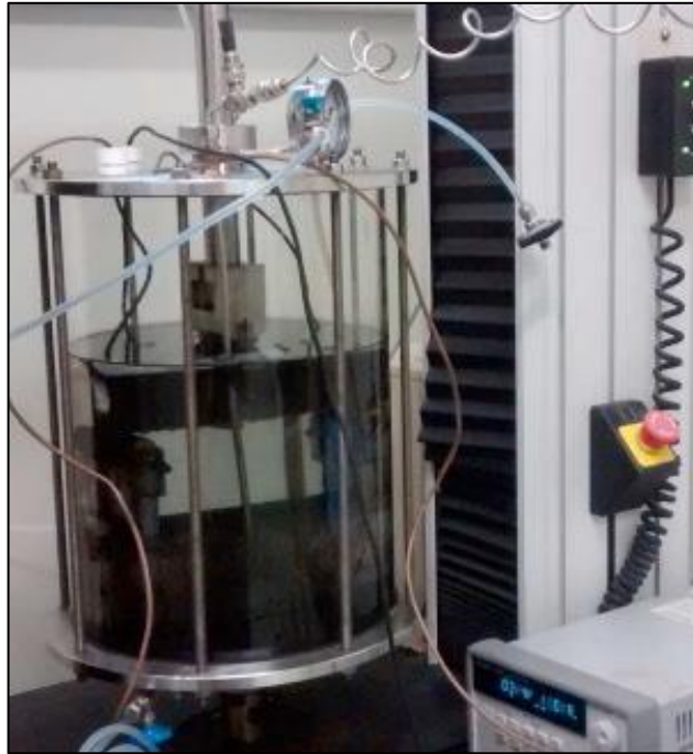
Figura 26. Aparato experimental durante realização de ensaio de fratura monotônica em material exposto ao meio agressivo.
