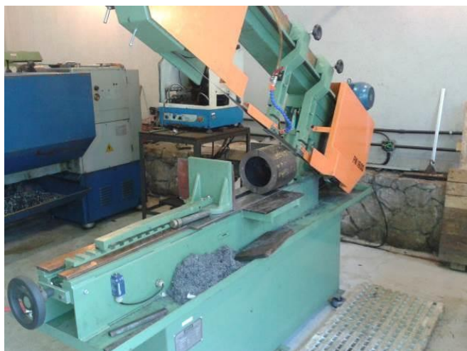
Figura 30: Corte no sentido longitudinal de laminação das amostras.
