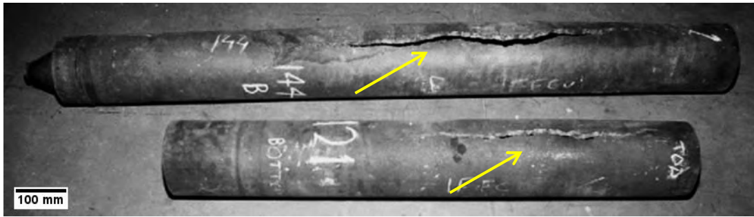
Figura 2.41. Aspecto macroscópico das trincas longitudinais após um evento de superaquecimento localizado (Adaptado de [124]).
