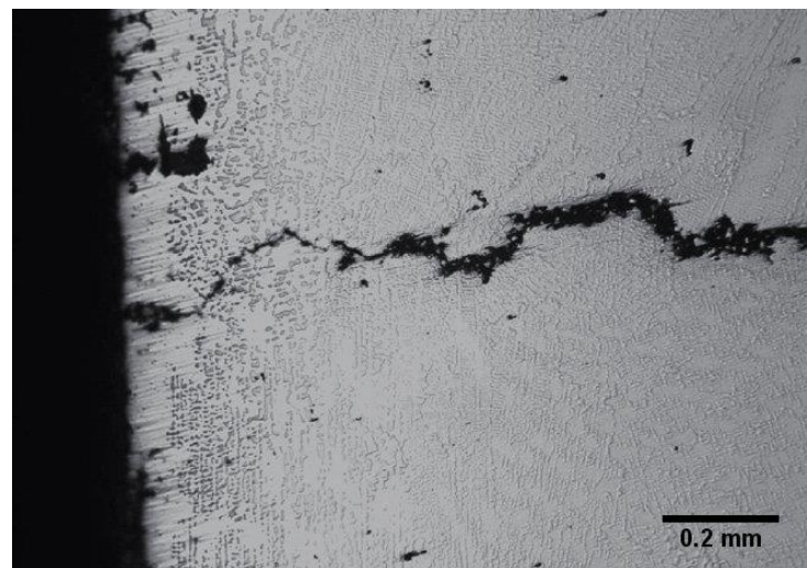
Figura 2.39. Trinca propagada a partir da parede interna de um tubo de reforma (Adaptado de [97]).
