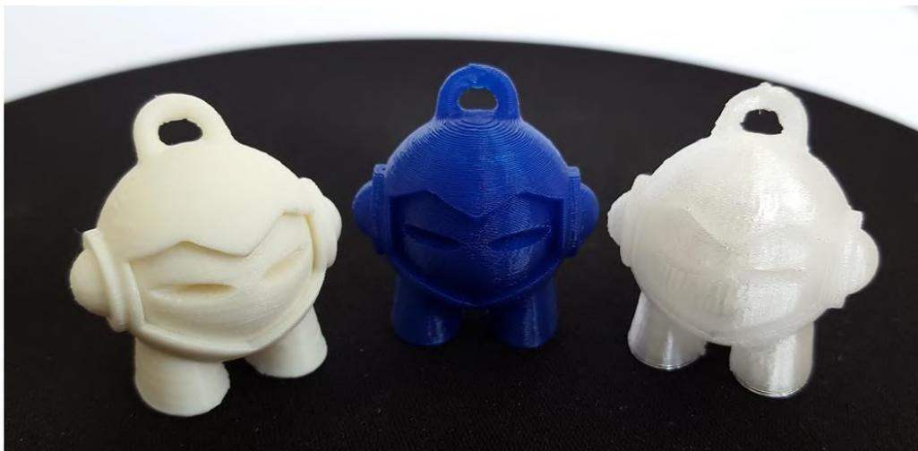
Figura 45: Peças de diferentes materiais impressas na FDM. Fonte: Impressão 3D Fácil (2015)
