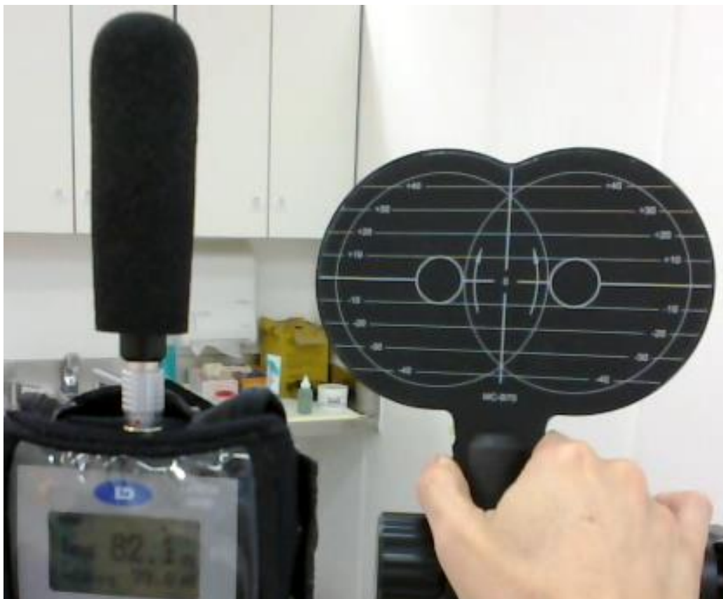
Figura 3.3. Medida do pico de intensidade de pressão sonora da bobina, medido com 10 cm de distância, com a saída do estimulador na intensidade máxima.
