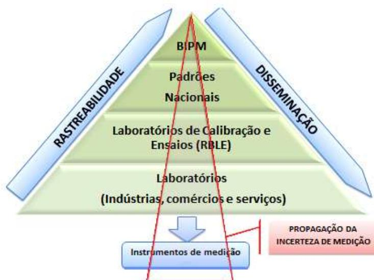
Figura 1. Fluxo hierárquico do sistema metrológico (Fonte <http://www.calibracaoceime.com.br/2013/02/artigos-tecnicos-rastreabilidade/>).
