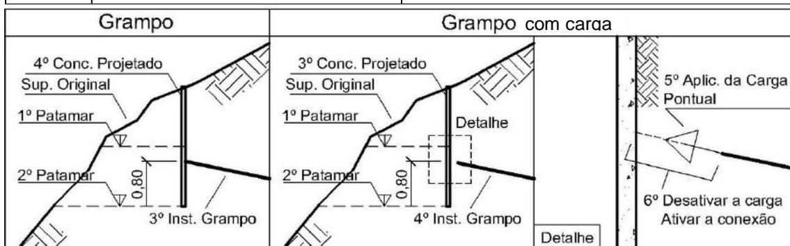
Figura 4.39 - Ordem de instalação das estruturas para os grampos na Ocorrência 2A
