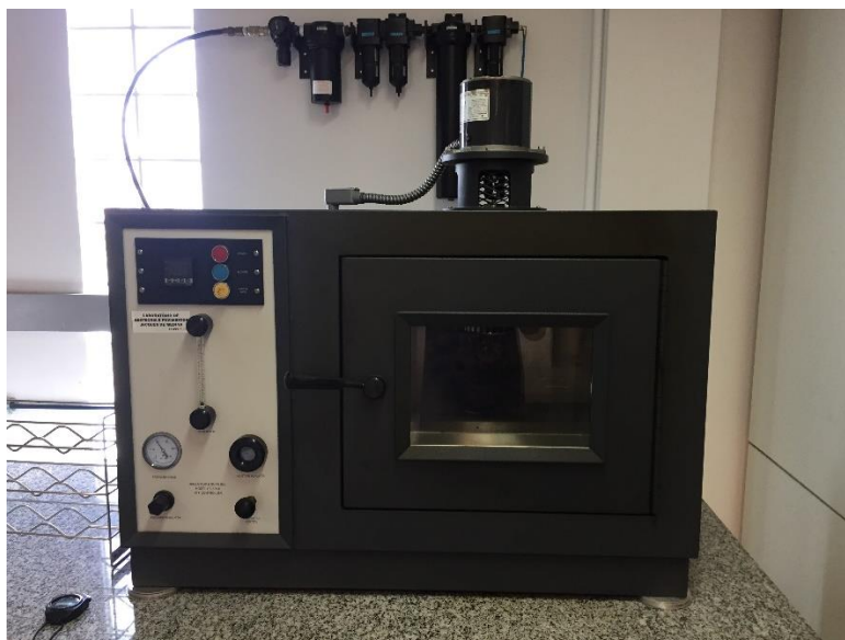
Figura 3.16: Estufa de filme fino rotativo para simular envelhecimento a curto prazo
