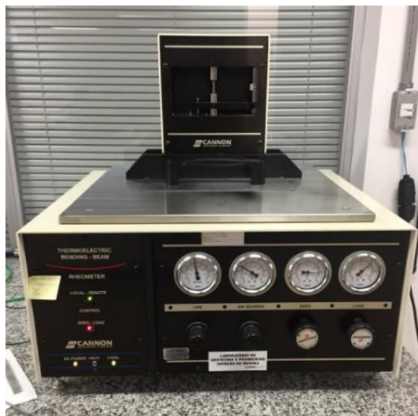
Figura 3.18: BBR utilizado nesta pesquisa para realização dos ensaios
