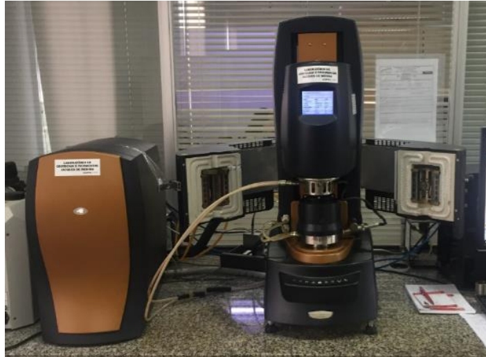
Figura 3.17: DSR utilizado nesta pesquisa para realização dos ensaios
