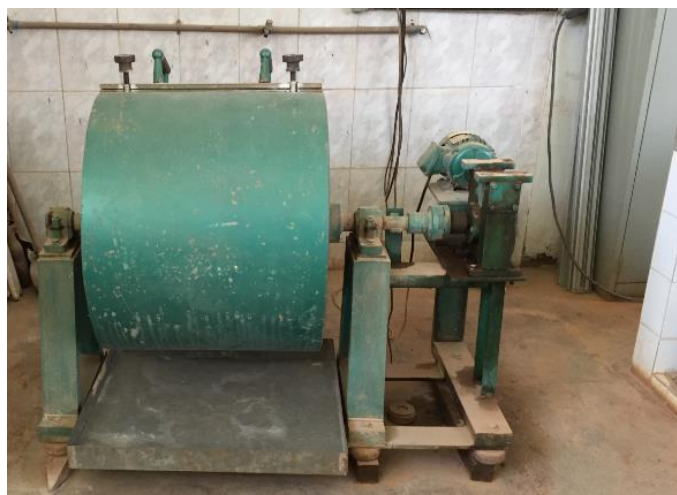
Figura 3.10: Equipamento de abrasão Los Angeles utilizado para o desgaste dos agregados desta pesquisa
