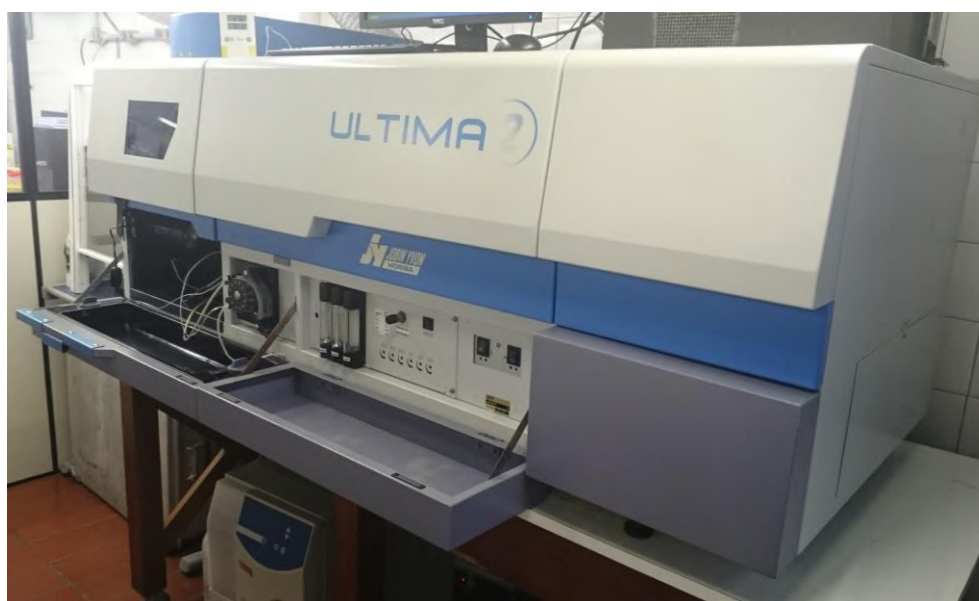
Figura 5 - Espectrômetro de emissão ótica com fonte de plasma indutivamente acoplado (ICP OES) utilizado na determinação dos analitos de interesse nos extratos de solos.
