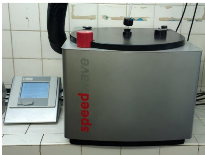
Figura 3 - Forno de micro-ondas da marca Berghof, modelo speedwave four (Eningen, Alemanha) utilizado para a extração dos elementos de interesse pelo método US EPA 3051A.
