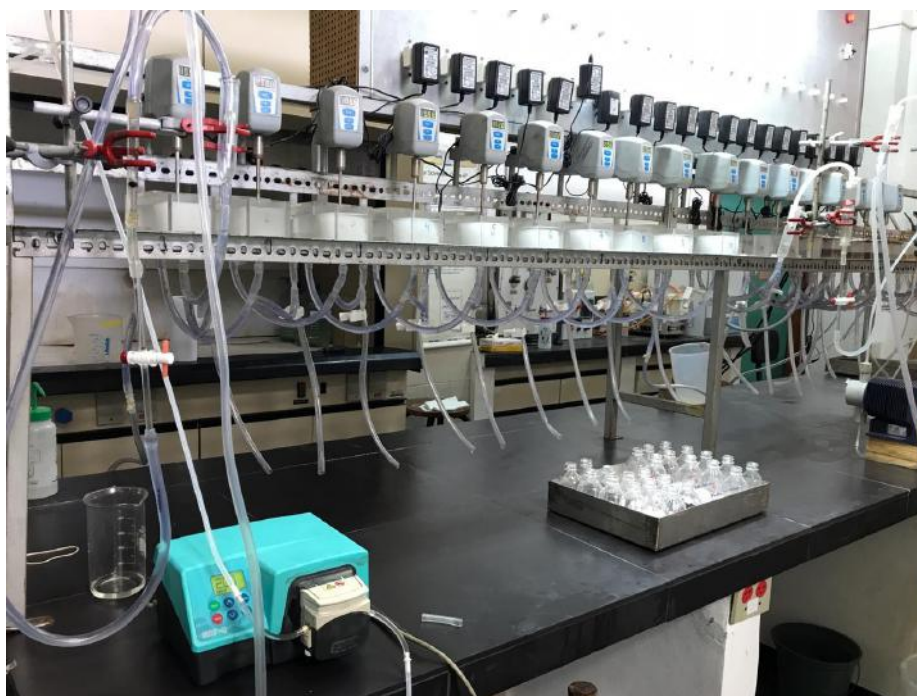
Figura 3-6: Planta de extração em regime contínuo em escala semi-piloto
