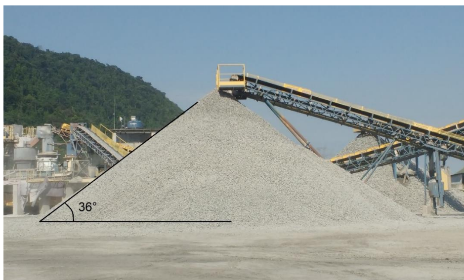
Figura 5.53 - Pilha de brita 3, ilustrando o ângulo de repouso referentes às britas da Mineração Santa Luzia
