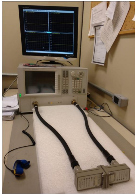
Figura 4-15: Equipamento utilizado para as medidas de blindagem e absorção (A); molde de metal utilizado (1) e amostra pós corte e desbaste (2) (B)
