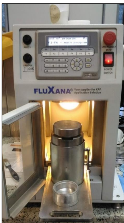
Figura 4-6: Prensa automática para VANEOX prensagem de pastilha de FRX (A); Equipamento de fluorescência de raios X utilizado (B).
