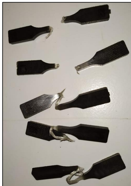
Figura 5-8: Fotografia da amostra com 5% de carga sob esforço no equipamento (A); amostras com 5% de carga pós rompimento (B)
