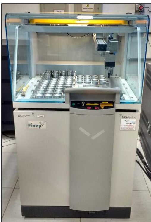
Figura 4-6: Prensa automática para VANEOX prensagem de pastilha de FRX (A); Equipamento de fluorescência de raios X utilizado (B).
