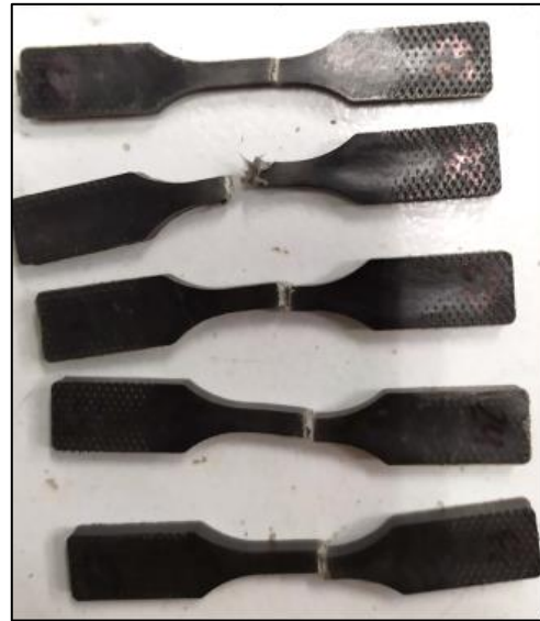
Figura 5-9: amostra com 20% de carga nas garras do equipamento de tração já apresentado rompimento (seta) (A); amostras, com 20% de carga, rompidas (B)
