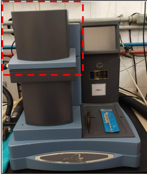
Figura 4-14: Equipamento utilizado para o ensaio de DMA, linha tracejada marca a região onde a amostra é colocada (A); Suporte da amostra (B): amostra (1), garra fixa (2), garra móvel (3)
