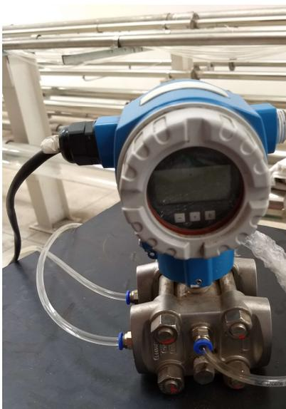
Figura 3.20: Medidor de pressão DeltaBar S, range 0 a 500 mbar
