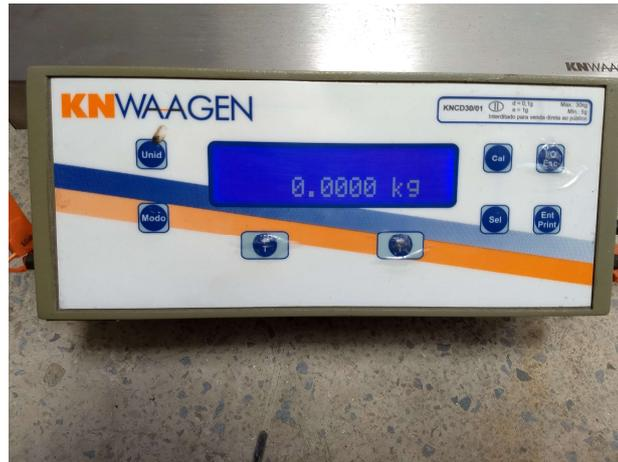
Figura 3.8: Balança para pesagem das partículas
