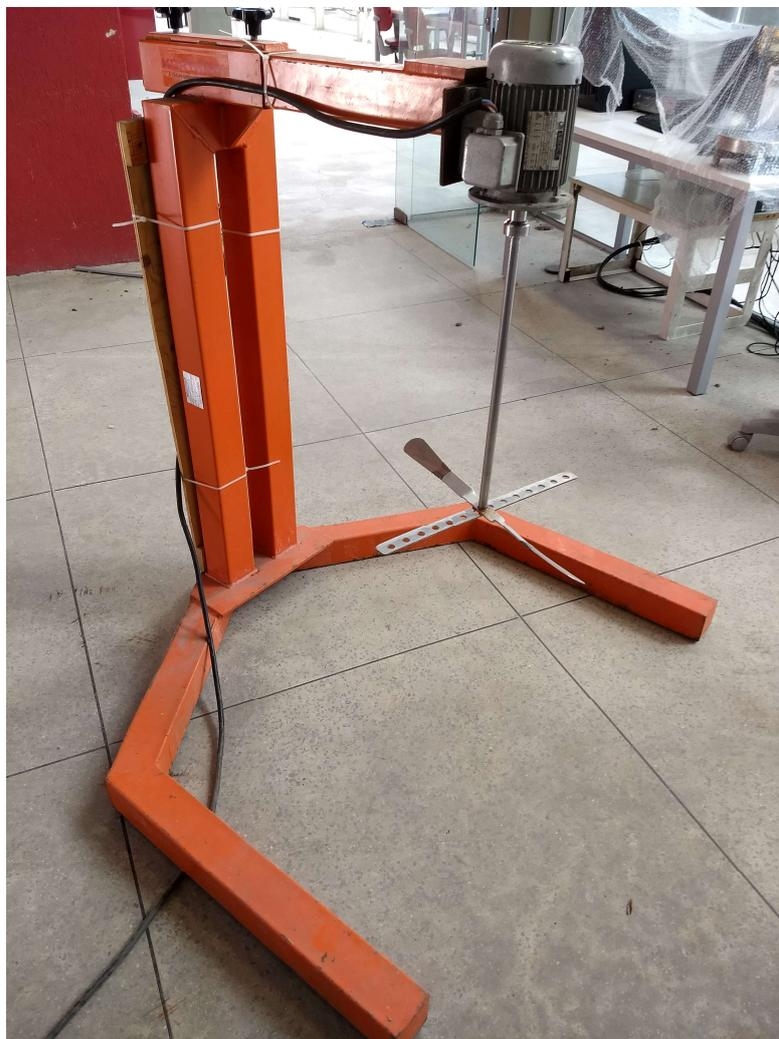
Figura 3.5: Aparato para suportar o misturador, com o motor e o hélice
