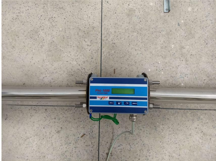
Figura 3.21: Medidor de vazão eletromagnético Incontrol Pro 1000
