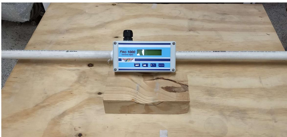
Figura 3.6: Medidor de vazão Incontrol, modelo PRO 1000
