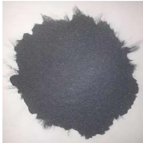
Figura 3.3: Carbetto de silício malha 100
