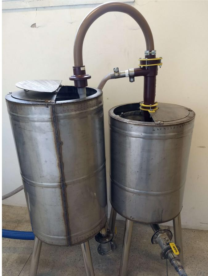
Figura 3.7: Tanques de coleta de partículas, juntamente com o separador ciclônico
