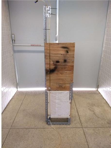
Figura 3.13: Aparato para a realização da calibração
