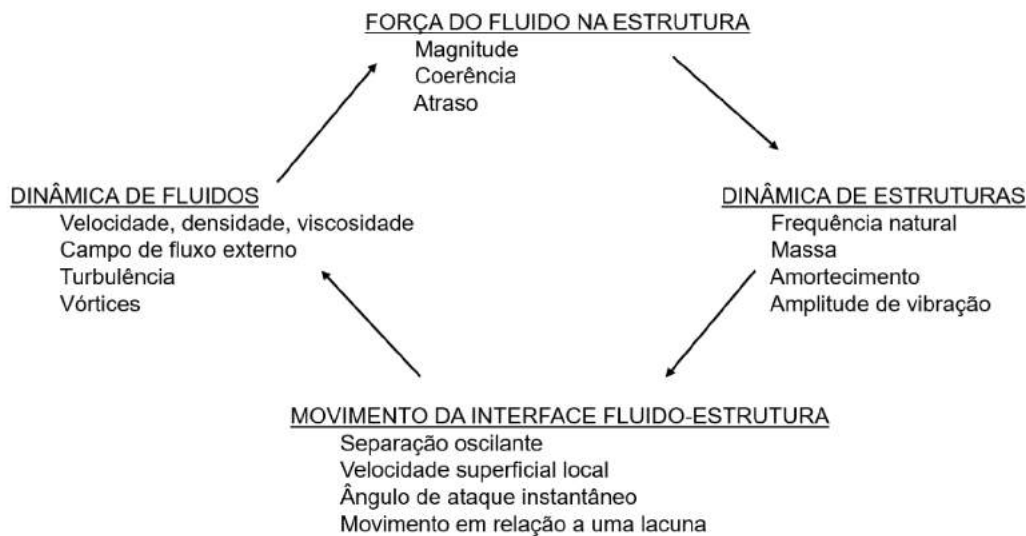
Figura 2.1: Interação entre o fluido e estrutura (adaptado de Blevins (1990) [7]).
