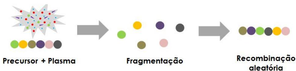
Figura 11 – Etapas do mecanismo de polimerização atômica.
