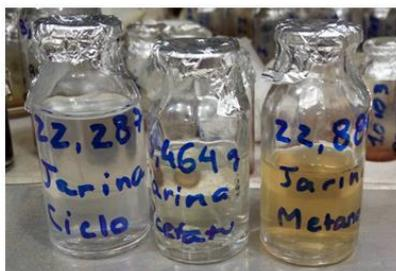
Figura 74 - Frações obtidas durante determinação do teor de extrativos: ciclohexano (esquerda), acetato de etila (centro) e metanol (direita).
