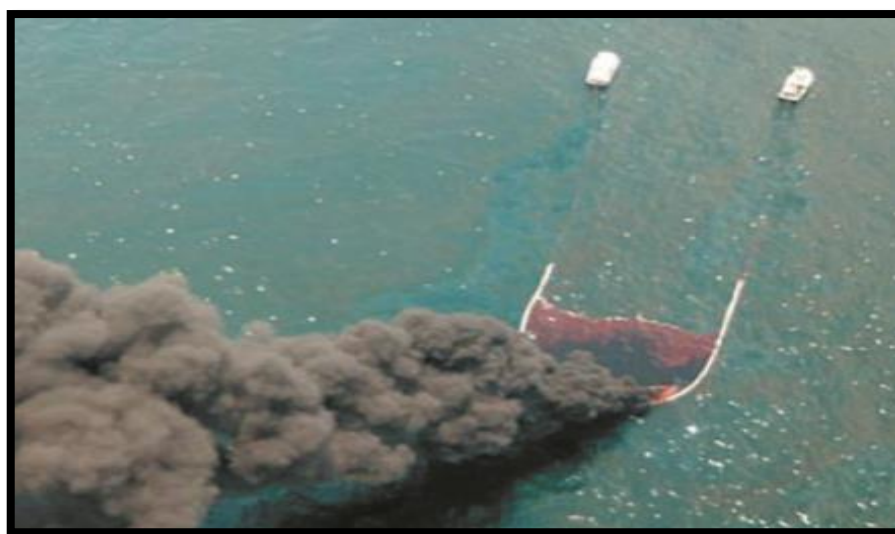
Figura 18: Queima controlada in situ. Fonte: (IPIECA, 2015).
