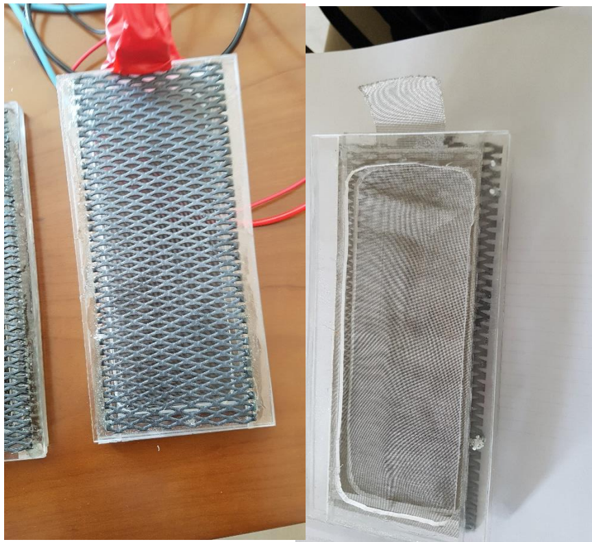
Figura 4.21 – Placa com os eletrodos de Ti/RuO 2 -Inox (ânodo – cátodo).
