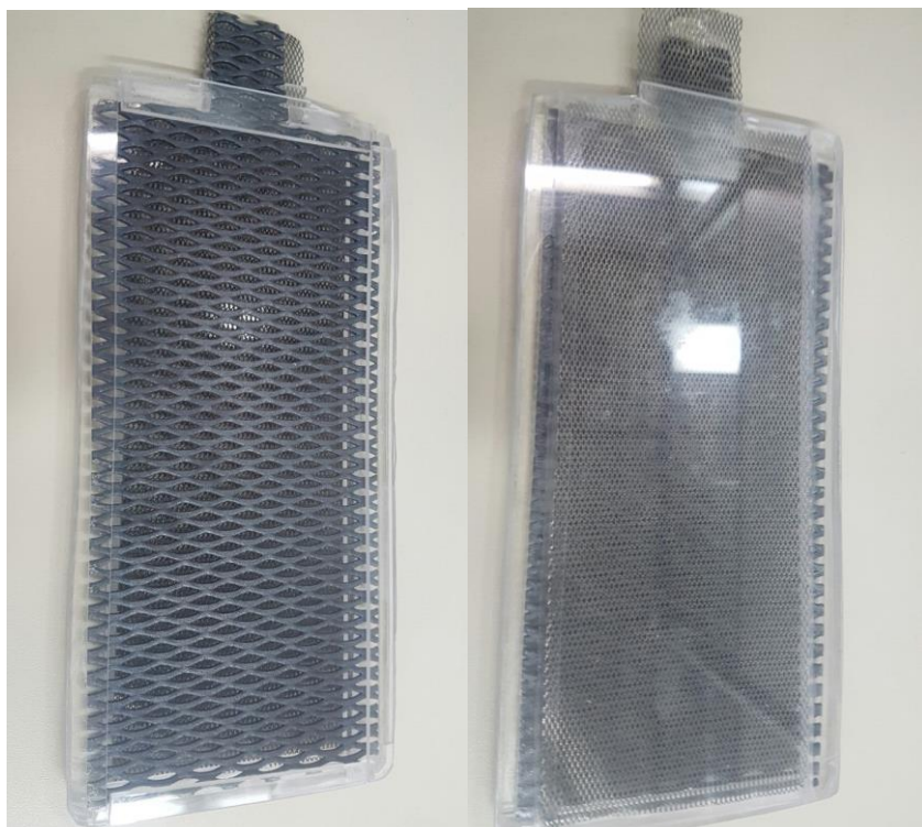
Figura 4.19 – Placa com os eletrodos de \text{Ti/RuO}_2 - Ti (ânodo – cátodo).
