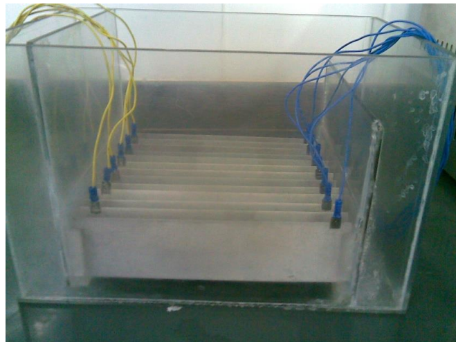
Figura 4.6 - Reator de maior dimensão montado em chapas de acrílico de 4,0 mm e eletrodos de Al.
