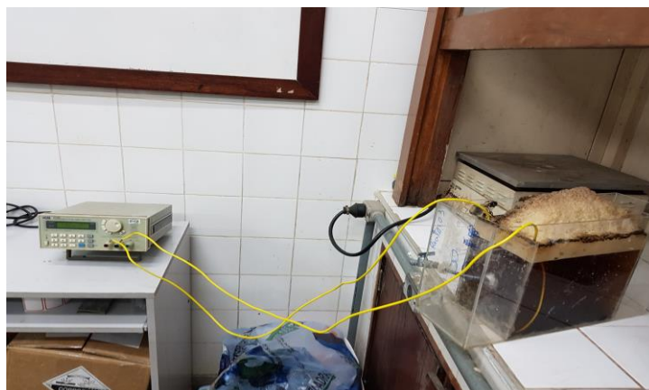
Figura 4.23 – Ensaio típico de eletro-oxidação com uso dos reatores menores.
