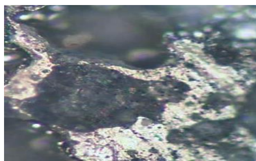
(b) Superfície do ânodo de alumínio depois do ensaio - (400 X).
