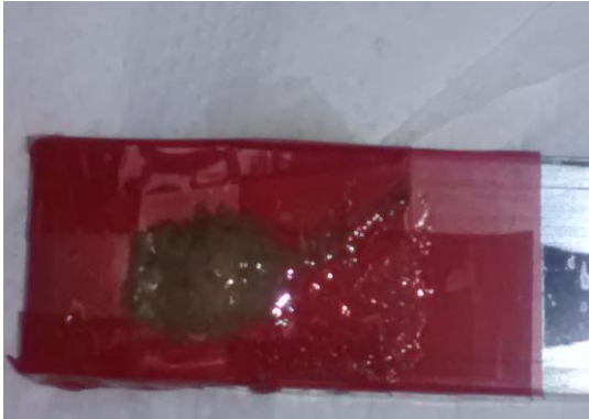
(a) Precipitação forte na placa com varredura de -4 a +4 V.
