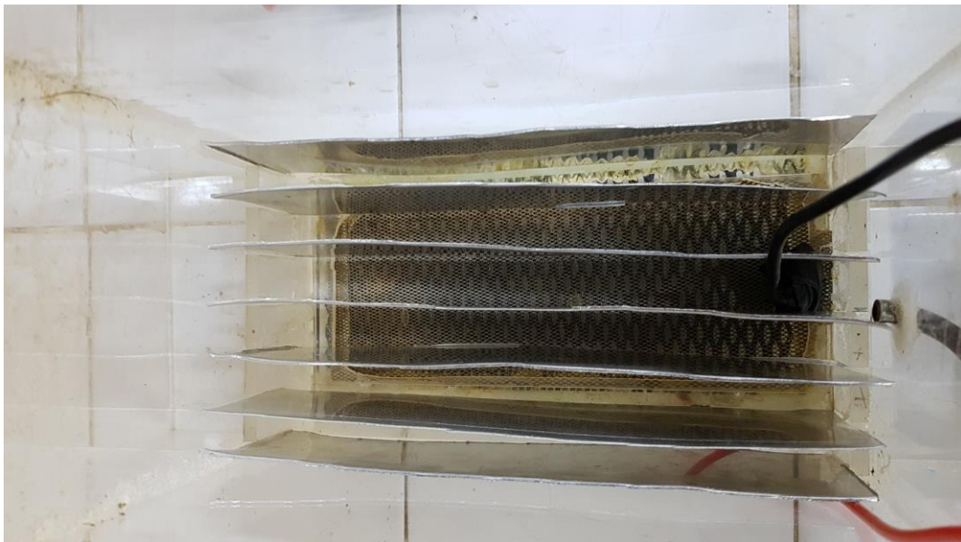
Figura 4.26 – Reator de eletrocoagulação-eletroflotação e eletro-oxidação combinados e simultâneos em um mesmo reator (Ti/RuO 2 – Ti).
