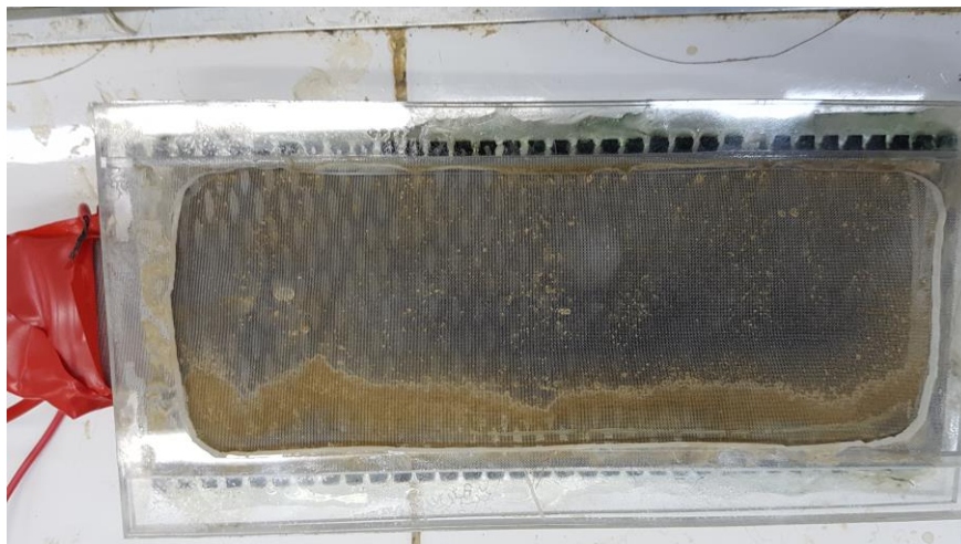
Figura 4.22 – Placa com os eletrodos de Ti/RuO 2 – Inox, no reator para o processo de eletro-oxidação.
