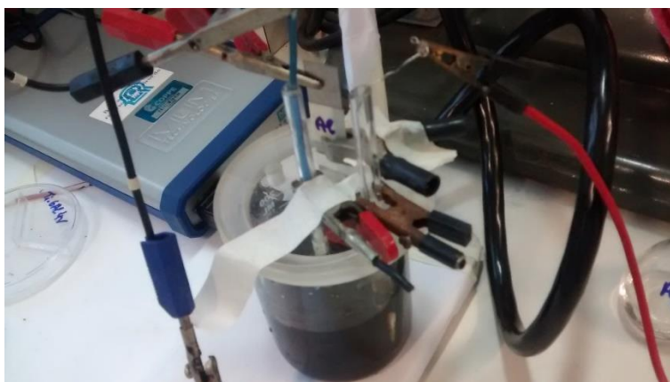
Figura 4.5 - Sistema utilizado na simulação preliminar com potenciostato.
