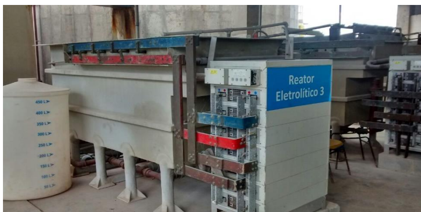
Figura 4.3 – Foto do reator eletroquímico do aterro BR/RJ 02.
