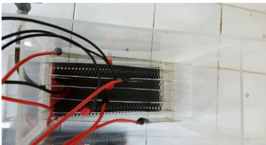
Figura 4.24 – Reator de eletrocoagulação-eletroflotação e eletro-oxidação combinados e simultâneos em um mesmo reator (Ti/RuO 2 - Ti/RuO 2 ).
