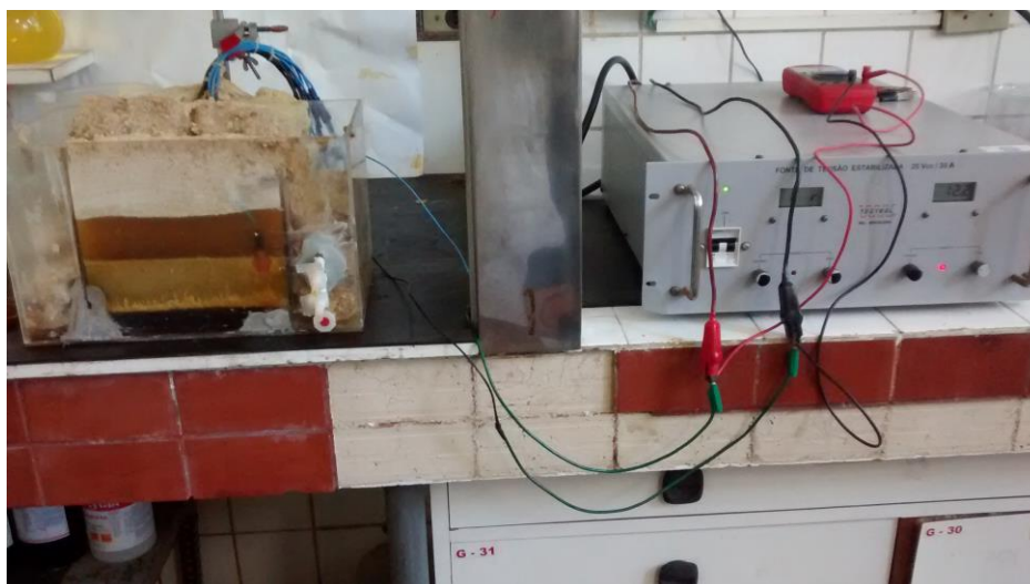
Figura 4.15 – Reator maior nos ensaios de eletrocoagulação-eletroflotação.
