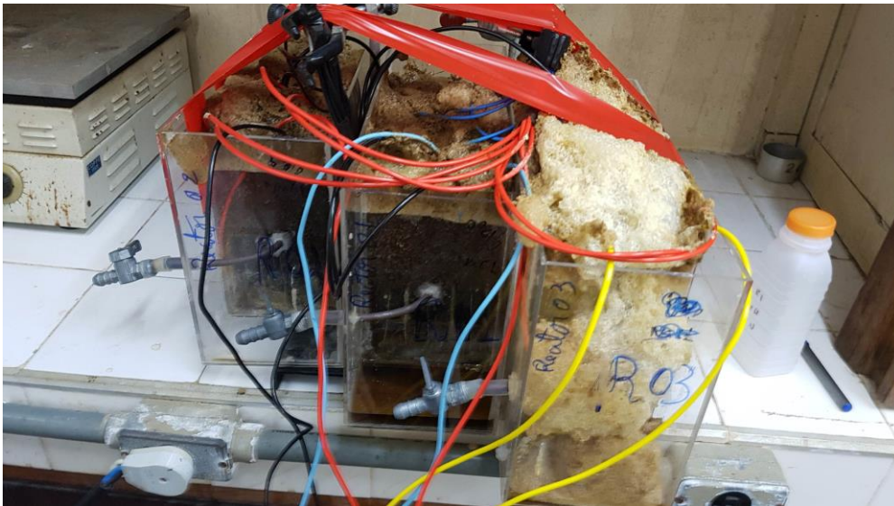
Figura 4.28 – Reatores de eletrocoagulação-eletroflotação e eletro-oxidação combinados e simultâneos em um mesmo reator (fim do ensaio).
