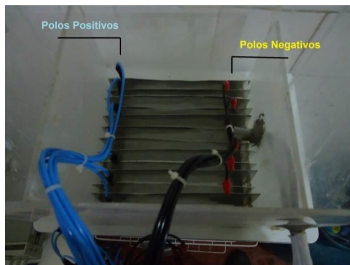
Figura 4.11 – Reator de maior dimensão (7,0 L) e a conexão dos eletrodos no seu interior.
