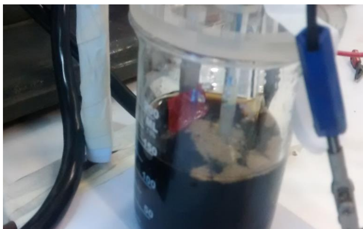
Figura 5.2 – Ensaio com potenciostato realizado com o lixiviado do aterro BR/RJ 01.
