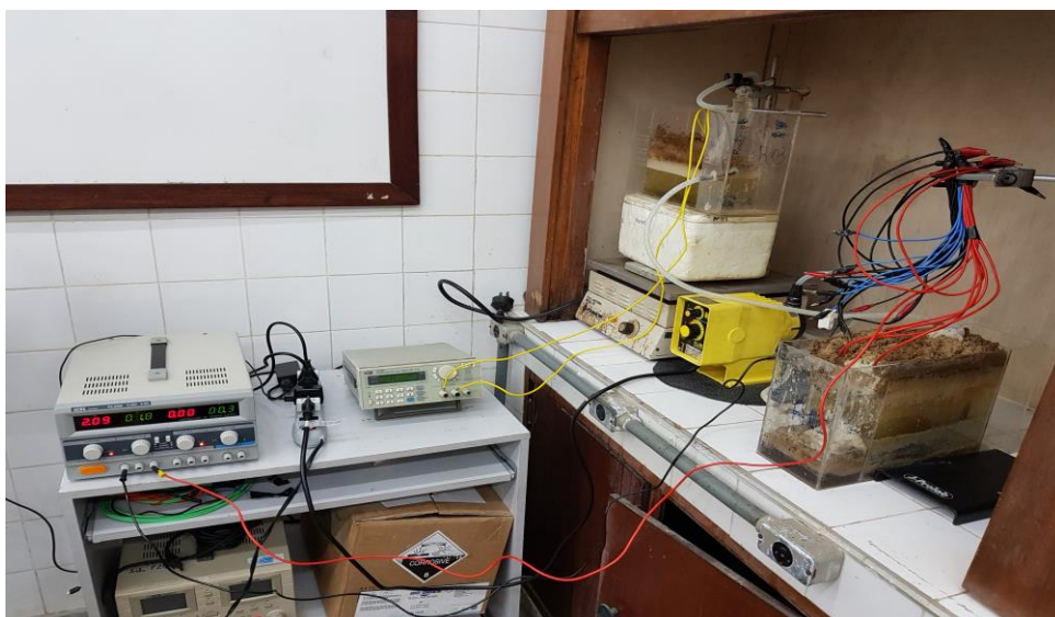
Figura 4.30 – Reatores de eletrocoagulação-eletroflotação e eletro-oxidação, com ensaios combinados e simultâneos (reatores separados).
