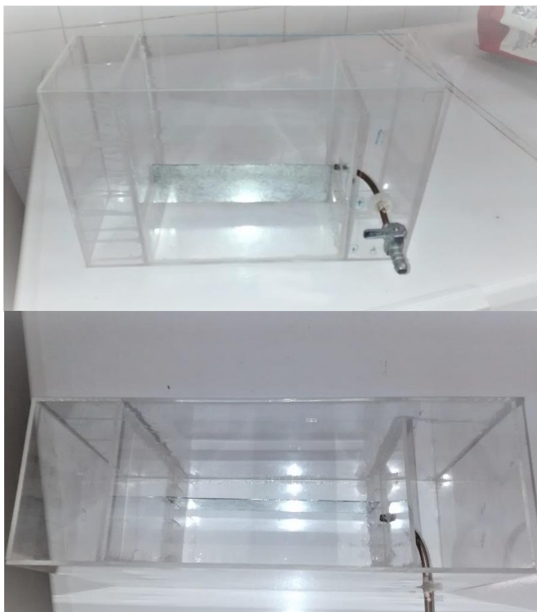
Figura 4.13 – Reator de menor dimensão utilizado nos ensaios de eletrocoagulação-eletroflotação, ensaios de eletro-oxidação e ensaios dos processos conjugados e simultâneos.
