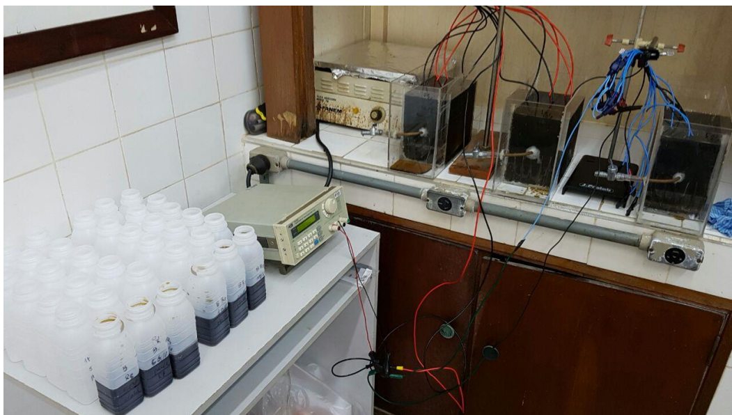
Figura 4.16 – Reatores menores nos ensaios de eletrocoagulação-eletroflotação.
