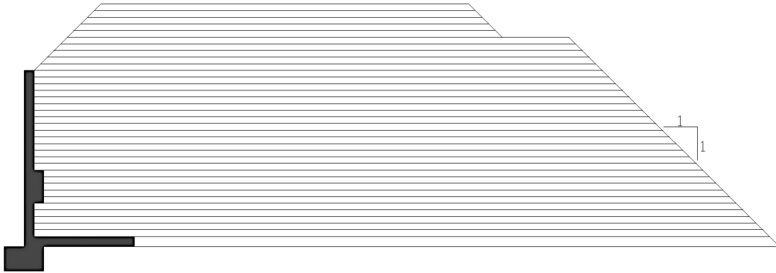
Figura 3.1 – Representação das camadas compactadas do aterro
