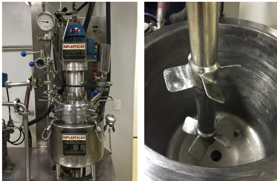
Figura 3.1: Reator da planta piloto em que foi produzida a carga polimérica padrão (esquerda) e esquema das pás do agitador (direita).
