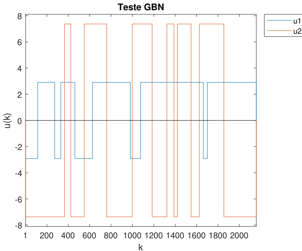
Figura 2.3: Exemplo de teste GBN (o processo em questão possui 2 entradas). Neste caso, \delta_1 = 2,91 , \delta_2 = 7,37 e p_1 = p_2 = 0,99 .
