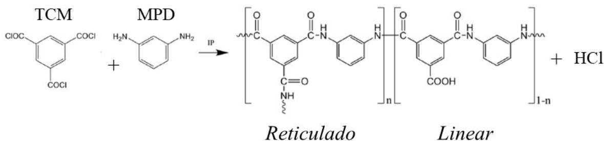
Figura 5.2 – Reação de formação da poliamida por polimerização interfacial (Adaptado de LOW et al. , 2015).
