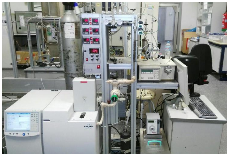
Figura 9. Unidade utilizada para avaliação catalítica dos catalisadores sintetizados.
