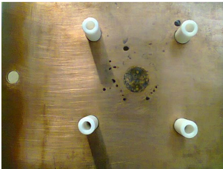
Figura 32: Foto do eletrodo de cobre desgastado após uma das análises de CEC feitas durante a dissertação de Mestrado. Nele podemos encontrar manchas pretas de óxido de cobre (II).
