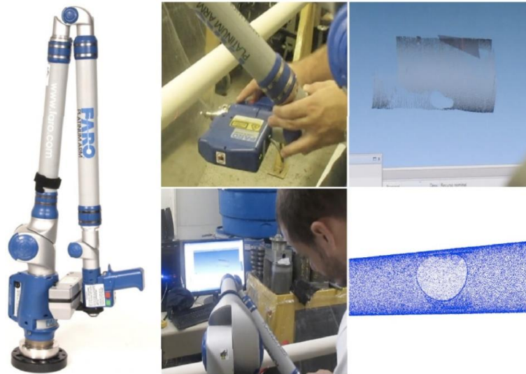
Figura 11: Medição de imperfeições das amostras experimentais por varredura laser.
