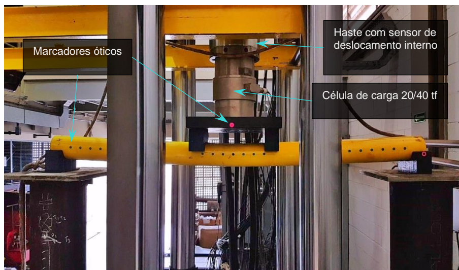
Figura 42: Exemplo da execução do ensaio de flexão por quatro pontos, Amostra S00.
