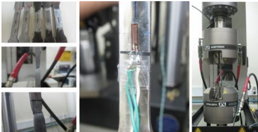
Figura 3: Testes de tração para obtenção das propriedades do material das amostras experimentais.
