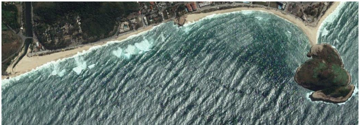
Figura 19. Foto de satélite da praia da Macumba (GOOGLE EARTH, 13/09/2017). Nota-se a incidência de ondas de sudeste (SE) na praia da Macumba em um ano pós El Niño muito forte durante o inverno no Rio de Janeiro e a destruição da linha de costa a oeste da pedra.
