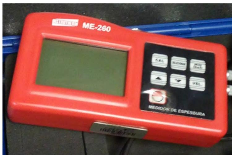
**Figura 4.10.** Aparelho medidor de espessuras.
