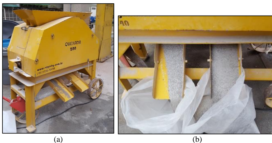
Figura 2.3 – Britador de mandíbulas móvel QUEIXADA 200: (a) equipamento; (b) saída da fração fina
