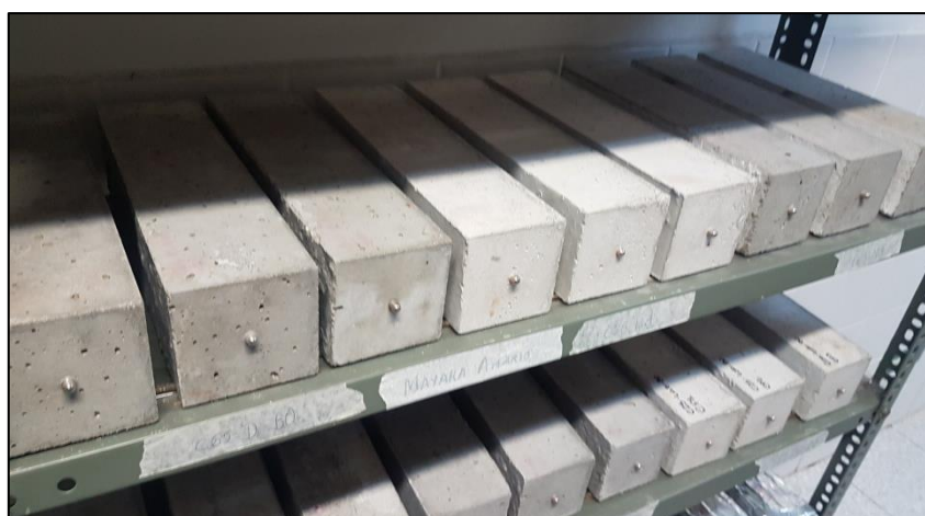
Figura 6.2 – Amostras para ensaio de retração por secagem após a cura de 28 dias
