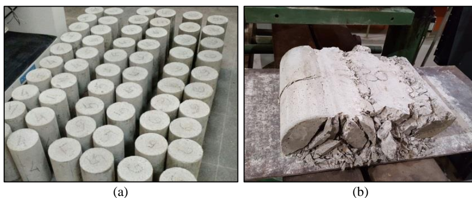
Figura 2.2 – Etapas da produção do resíduo RCA_L: (a) Corpos de prova do concreto de origem; (b) Concreto fragmentado após ruptura
