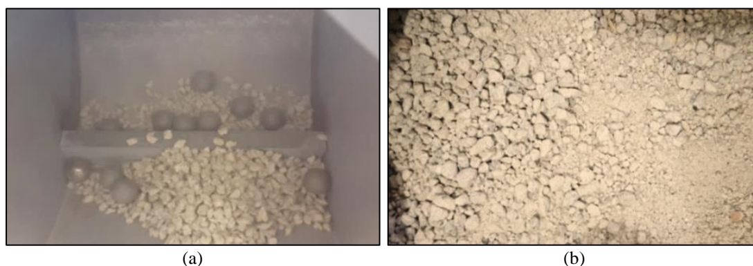
Figura 2.8 – Etapas do ensaio de abrasão “Los Angeles”: (a) amostra de material antes do ensaio; (b) amostra de material após o ensaio
