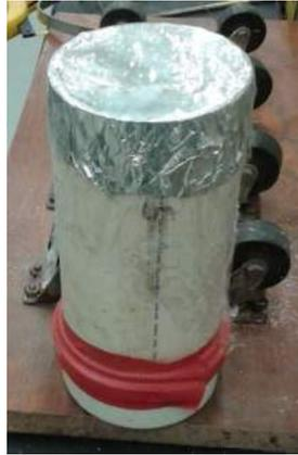
Figura 3.37: Trecho cortado para moldagem protegido para preservar a umidade.
