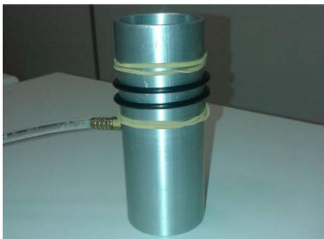
Figura 3.42: Posicionamento dos anéis de vedação e elásticos no encamisador.
