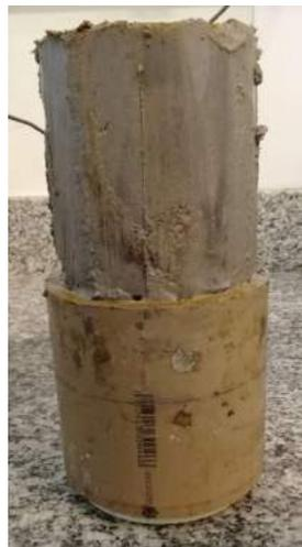
Figura 3.38: Extração da amostra com tarugo.
