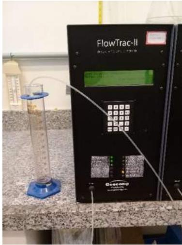
Figura 3.8: Calibração da medição de volume com proveta.
