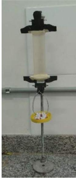
Figura 3.31: Determinação do módulo de elasticidade e coeficiente de Poisson da membrana.
