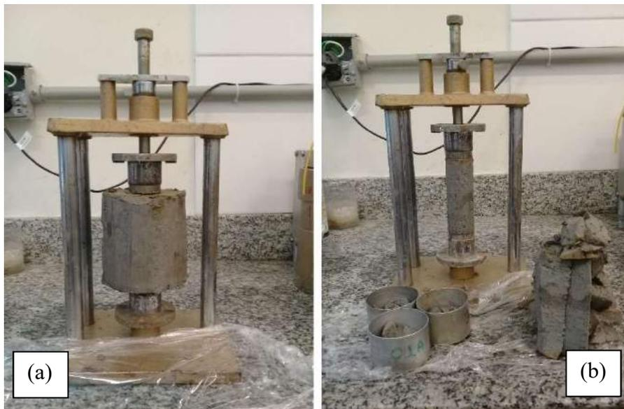
Figura 3.39: Moldagem do corpo de prova com torno: (a) antes e (b) depois do desbastamento.
