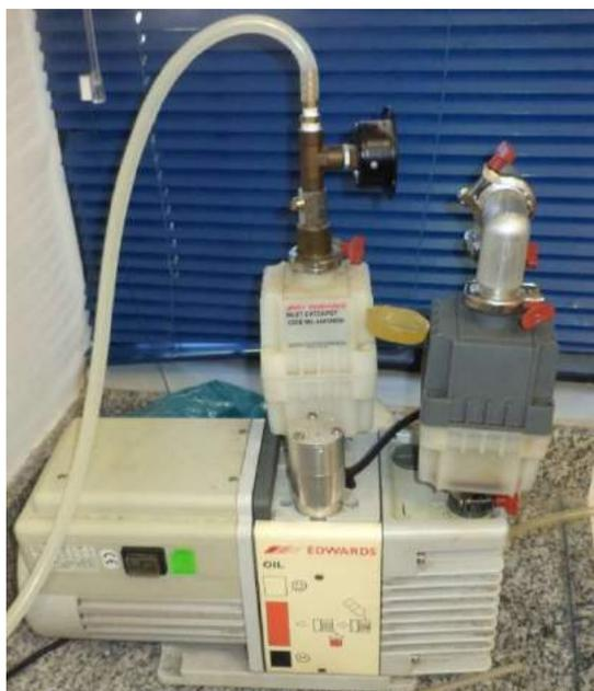
Figura 3.33: Bomba de vácuo modelo E-Lab 2 (Edwards) utilizada na presente dissertação.
