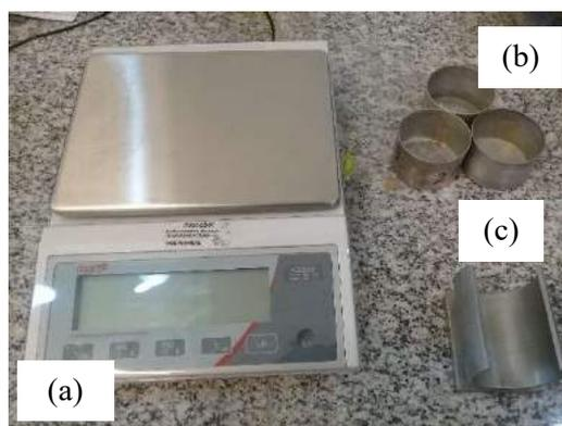
Figura 3.35: (a) Balança Marte utilizada, (b) cápsulas e (c) berço vazios e secos para determinação das taras.
