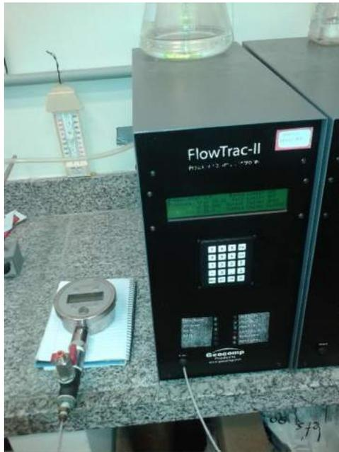
Figura 3.11: Verificação dos transdutores de pressão com manômetro digital.
