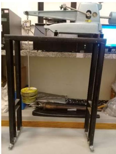
Figura 3.5: Calibração da célula de carga à tração.
