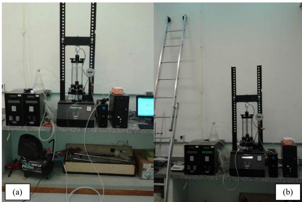
Figura 3.24: Medição do atrito com bomba de ar comprimido (a) e com coluna d'água (b).
