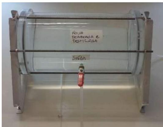
Figura 3.32: Reservatório superior de água decaerada.
