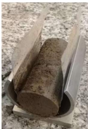
Figura 3.41: Berço utilizado na moldagem dos corpos de provas.
