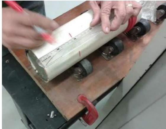
Figura 3.36: Suporte usado para corte do tubo de amostragem.
