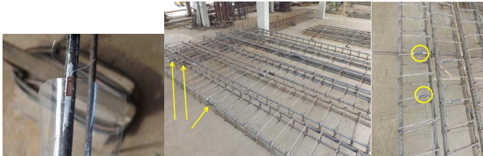
Figura 3.8: Extensômetros elétricos na armadura de aço.
