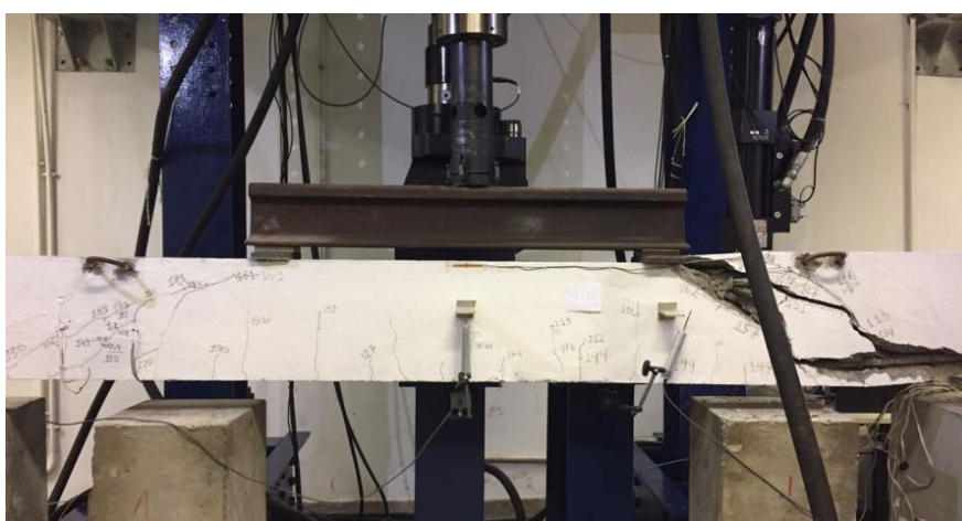
Figura 4.4: Ruptura viga E4-1.
