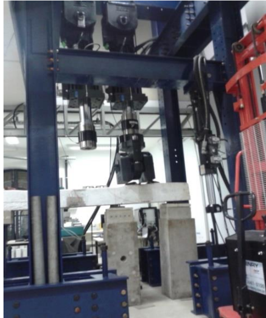
Figura 3.13: Pórtico e atuadores.
