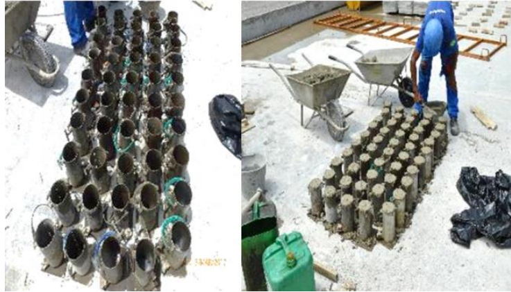
Figura 3.1: Moldagem dos corpos de prova de concreto 100 mm x 200 mm de dimensões em formas metálicas.
