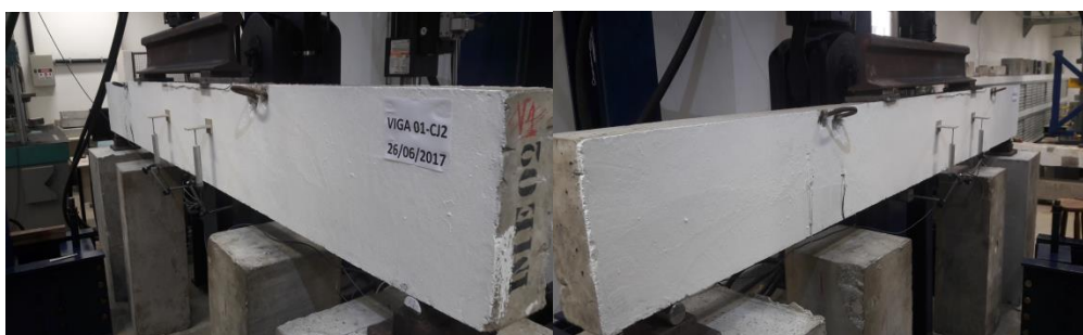
Figura 3.10: Viga posicionada no pórtico.
