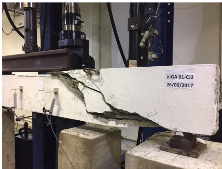
Figura 4.2: Ruptura viga E2-1.
