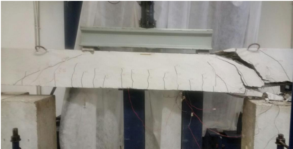
Figura 4.8: Ruptura viga F3-2.
