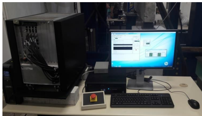
Figura 3.14: Controladora dos atuadores.
