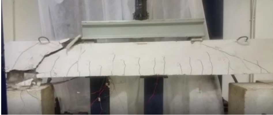
Figura 4.1: Ruptura viga E1-1.
