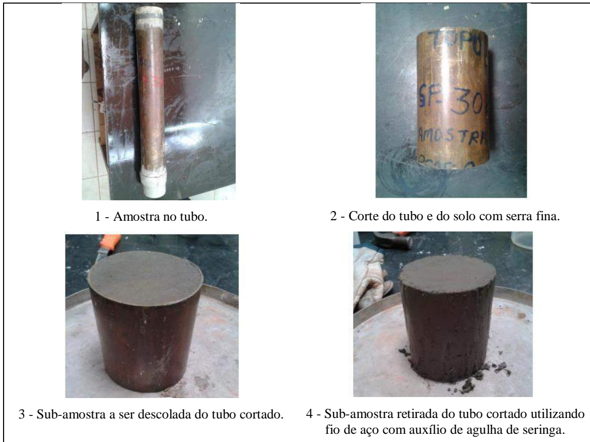
Figura 20- Exemplo do procedimento de extração do solo do tubo de amostragem realizado nas amostras apresentadas neste trabalho. (Fonte: Patrol Investigações Geotécnicas)
