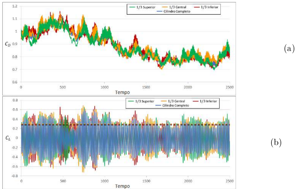
Figura 5.37: Histórias de tempo dos coeficientes (a) de arrasto - C_D ; (b) de sustentação - C_L - Caso 4
