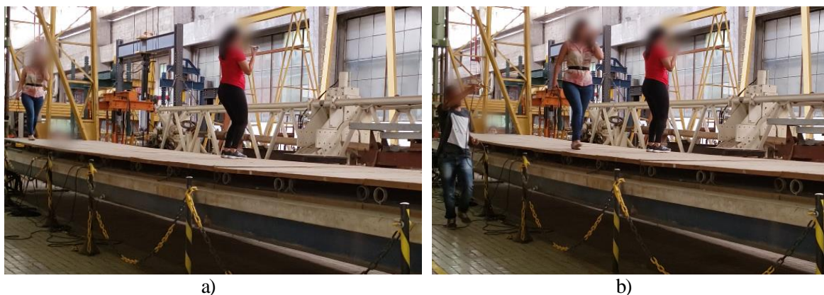
Figura 4.12: Ensaio vibração forçada com amplitude constante: a) Excitação imposta a estrutura; b) Pedestre caminhando em superfície flexível
