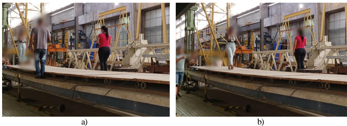
Figura 4.13: Ensaio vibração livre: a) Excitação imposta à estrutura; b) Pedestre caminhando em superfície sob vibração livre, após saída da fonte de excitação
