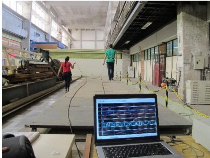
Figura 4.9: Ensaio pessoas caminhando em uma plataforma rígida instrumentada
