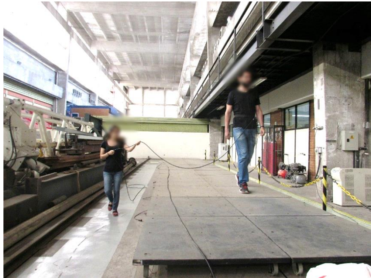
Figura 3.4: Ensaio de caminhada sobre estrutura rígida
