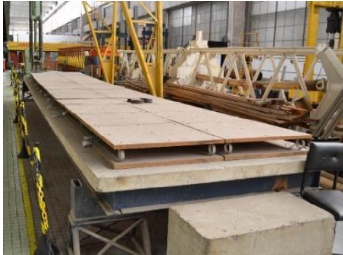
Figura 3.3: Estrutura flexível de passarela usada nos ensaios experimentais
