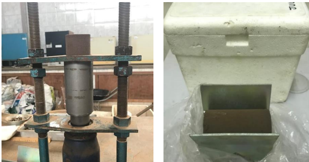
Figura 5.4. a) Extração do corpo de prova por um extrator de amostras hidráulico b) Isopor e berço utilizados no transporte do corpo de prova
