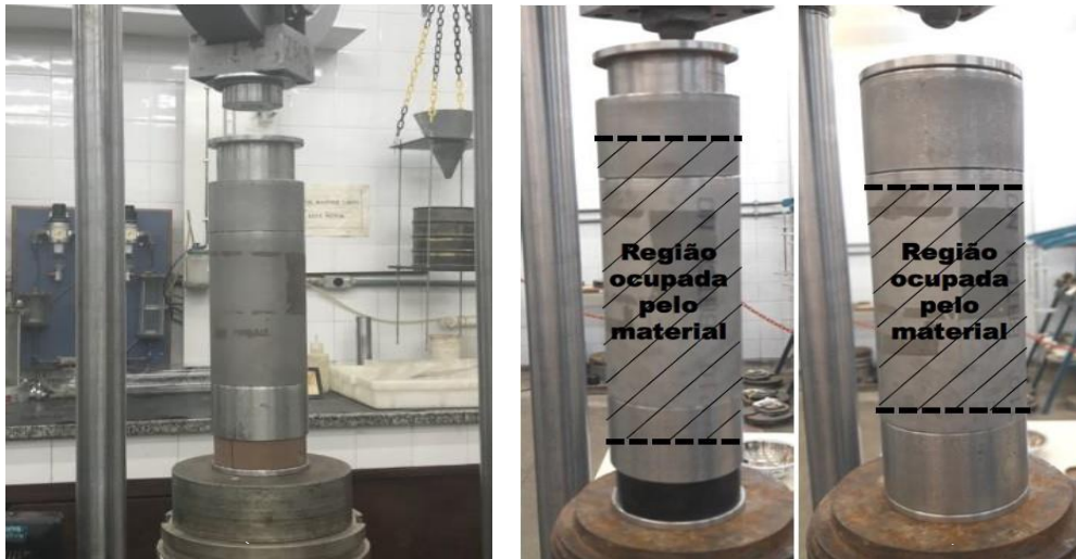
Figura 5.3. Etapas da compactação estática a) Sequência de montagem dos acessórios b) Volume ocupado pelo material antes (TELLES, 2017) c) Volume ocupado pelo material depois (TELLES, 2017).
