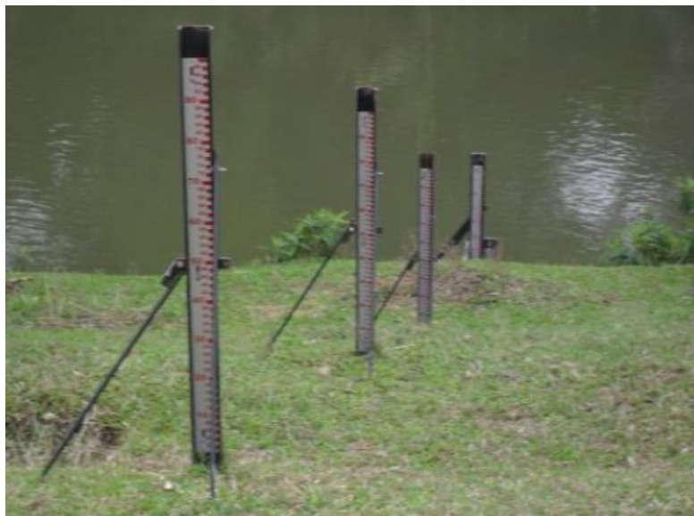
Figura 16: Exemplo de seções de réguas instaladas segundo os padrões da ANA Fonte: ANA, 2011.
