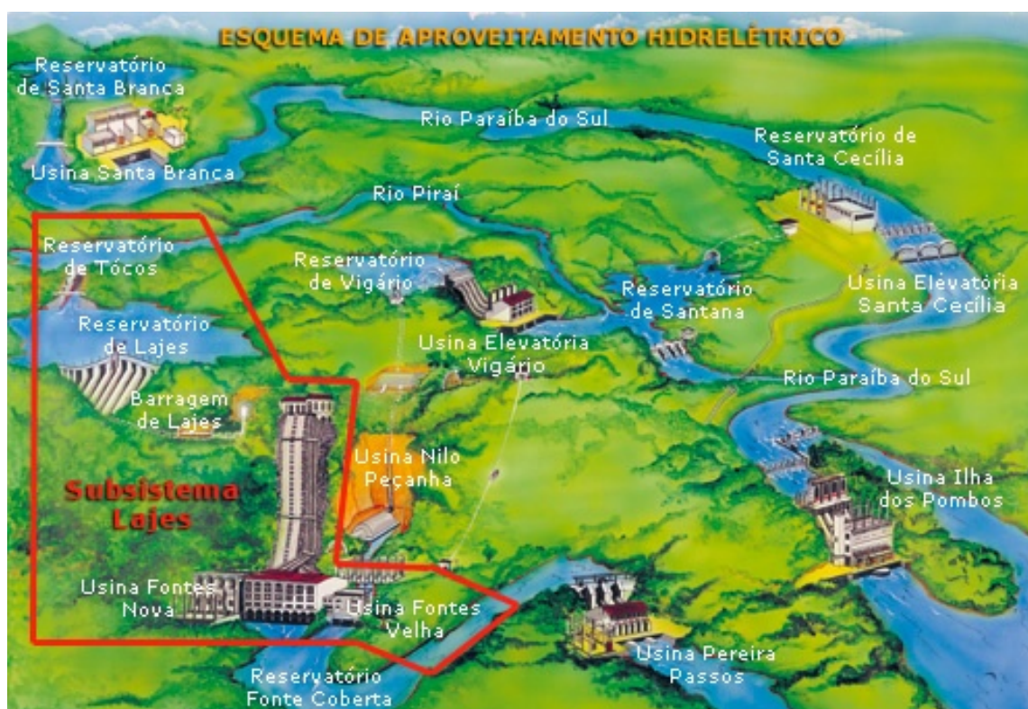
Figura 12: Esquema de aproveitamento hídrico do Subsistema Lajes Fonte: Oliveira, 2013.
