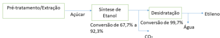
Figura 2-11: Esquema do processo para a produção de bioetileno
