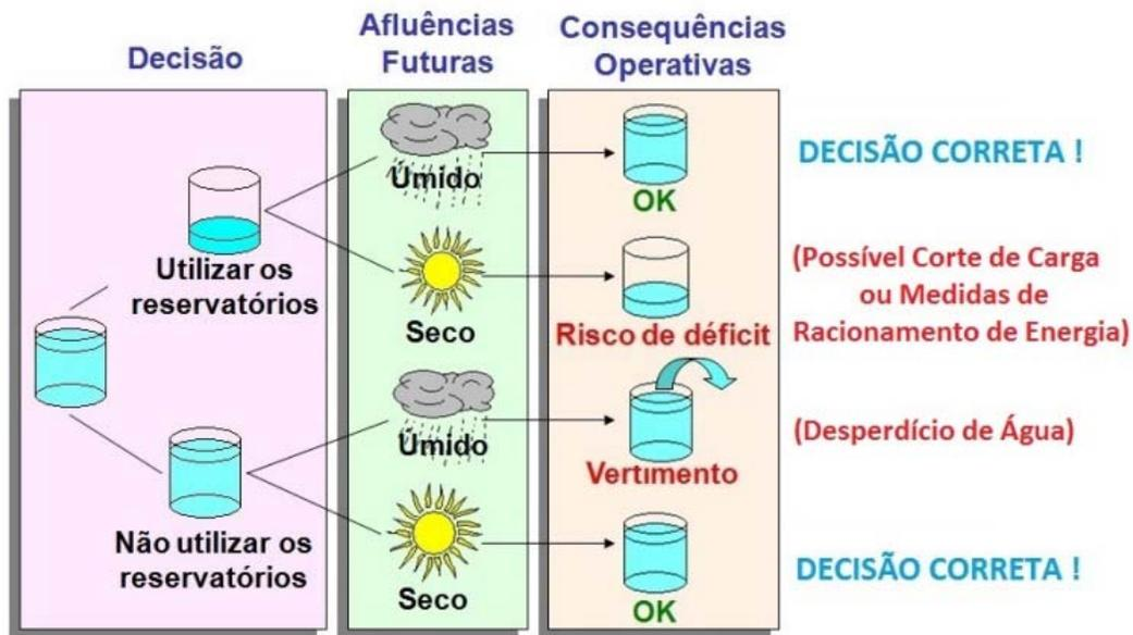
Figura 4-6: Processo de decisão em um sistema hidrotérmico.
