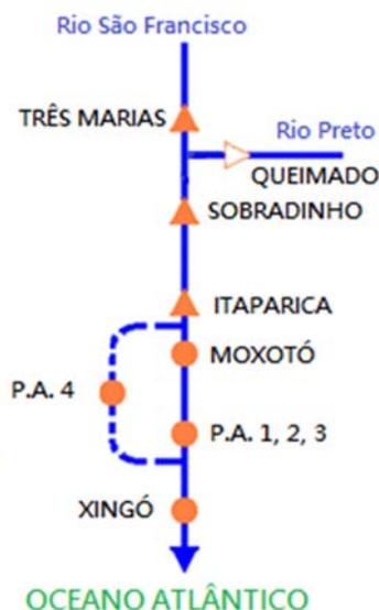
Figura 3-5: Representação da cascata com as principais UHEs da bacia.
