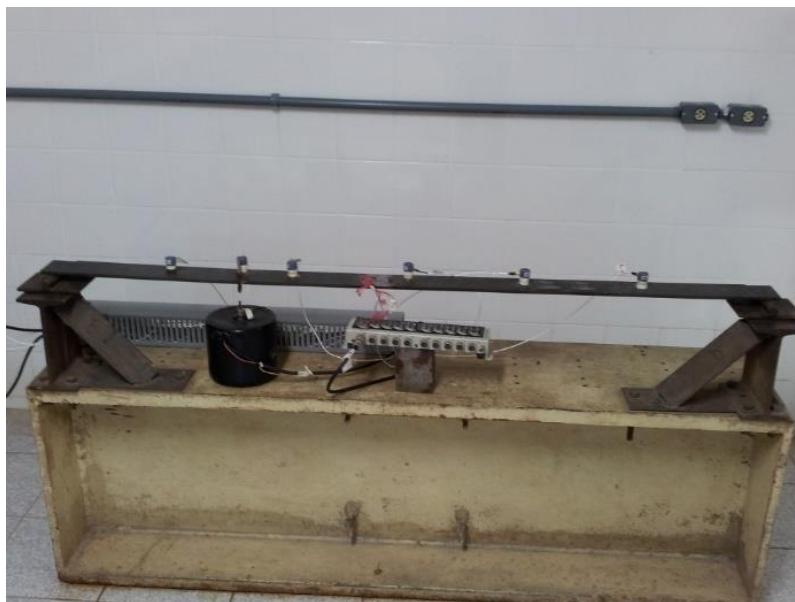
Figura VI-13 - Sistema de instrumentação da viga metálica no Laboratório de Estruturas da COPPE/UFRJ.
