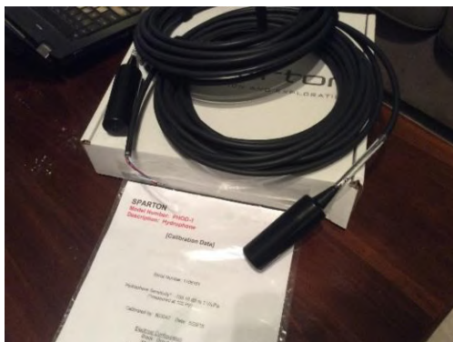
Figura 28: Hidrofone Sparton (modelo PHOD-1) e sua resposta em frequência.
