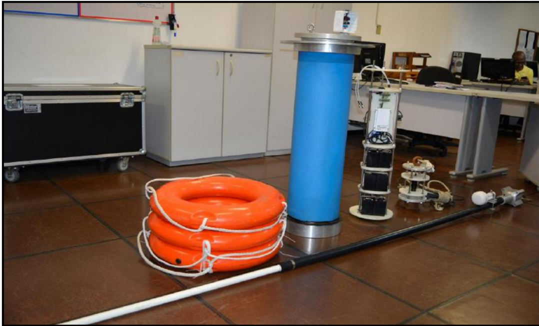
Figura 33: Componentes da boia da primeira versão. Fonte: CASOP.
