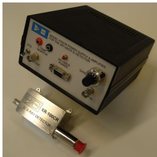
Figura 4.5 — Detector e sua fonte de alimentação PX2T/CR da Amptek.
