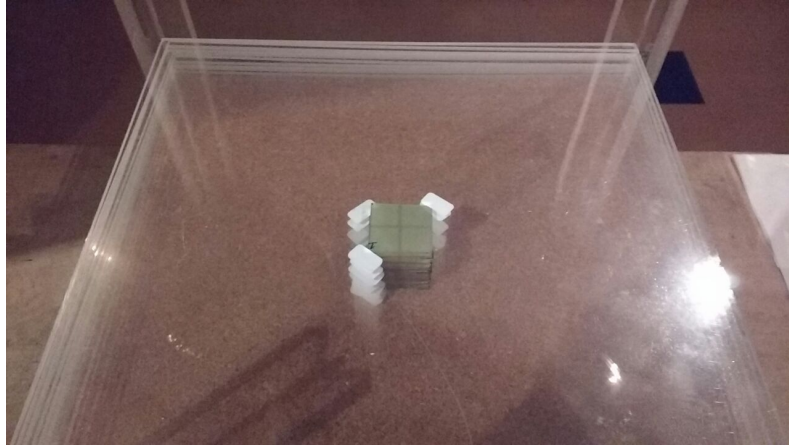
Figura 3.6 - Empilhamento dos filmes radiocrômicos através do acrílico na camada 1. (Radioterapia/INCA)
