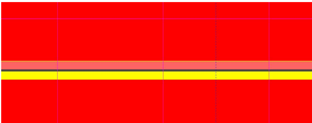
Figura 4.5 - Ilustração representando a ampliação do filme radiocrômico, situado entre as subcamadas de acrílico. Elaborada pelo aplicativo Moritz (LAASC/COPPE).
