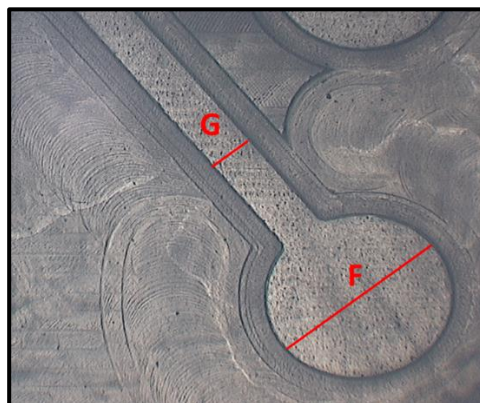
Figura 4-4. Imagem da região entrada da salmoura, obtida no molde em acrílico através do microscópio Hyrox, com a identificação de cada um dos canais e código de letras para correlação na respectiva tabela.
