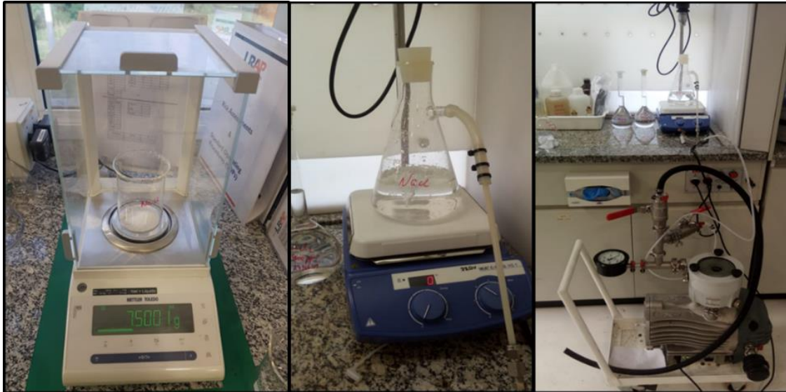
Figura 3-8. Pesagem do sal para preparação da salmoura na concentração desejada (esquerda); Amostra no agitador para homogeneização (centro); Bomba de vácuo para remoção do gás dissolvido na água deionizada (direita).
