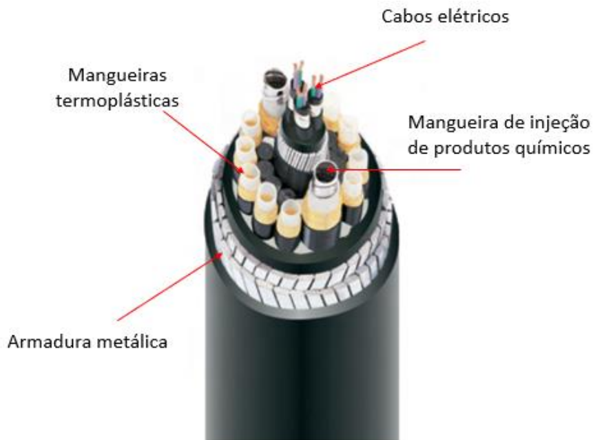
Figura 2.53 - Cabo umbilical submarino com mangueiras de controle hidráulico em material termoplástico (Adaptado de: <tecnologiademateriais.com.br>. Acesso em: 12 nov. 2018)
