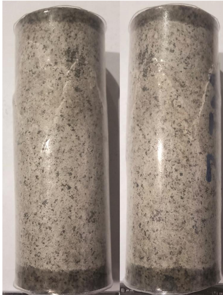
Figura 28: Lado B - Rompimento do W1-2 na tensão confinante de 10 MPa e tensão desviadora de 486,24 MPa.
