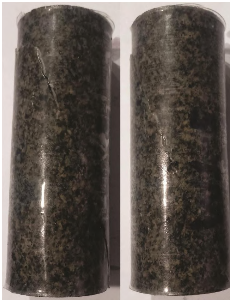
Figura 30: Lado B - Rompimento do W1-5 na tensão confinante de 15 MPa e tensão desviadora de 537,94 MPa.
