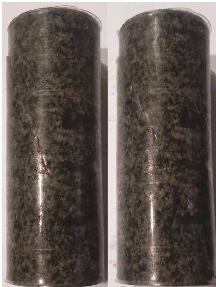
Figura 29: Lado A - Rompimento do W1-5 na tensão confinante de 15 MPa e tensão desviadora de 537,94 MPa.
