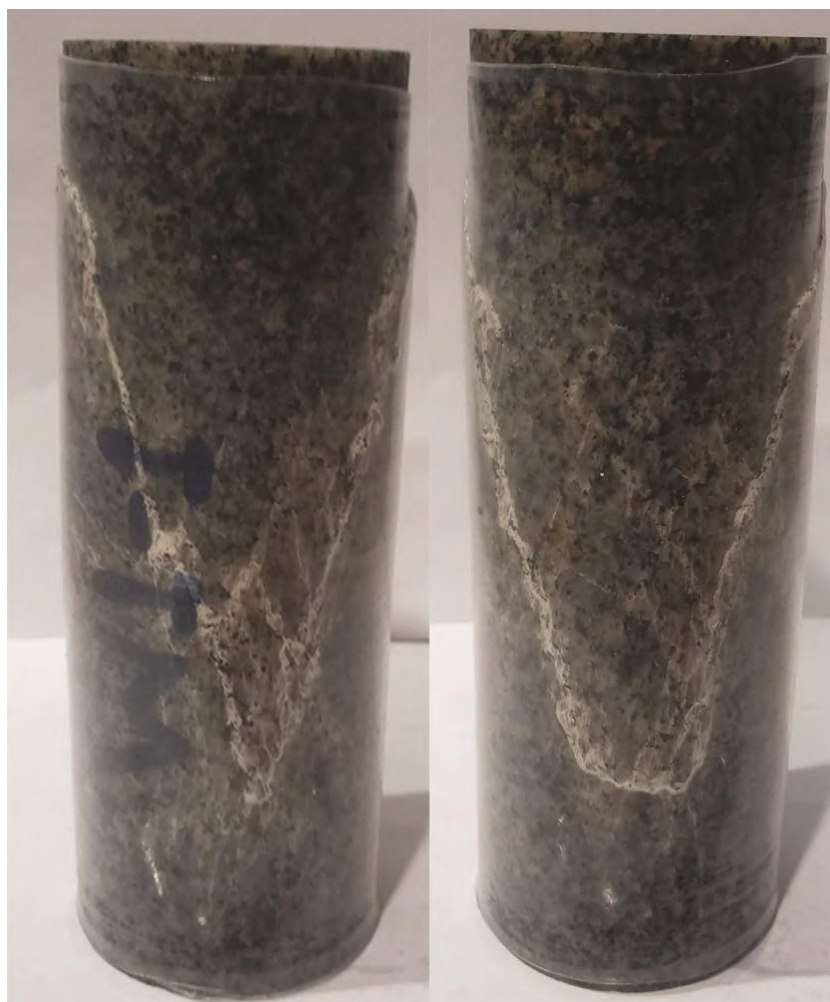
Figura 26: Lado B - Rompimento do W1-1 na tensão confinante de 5 MPa e tensão desviadora de 356,26 MPa.
