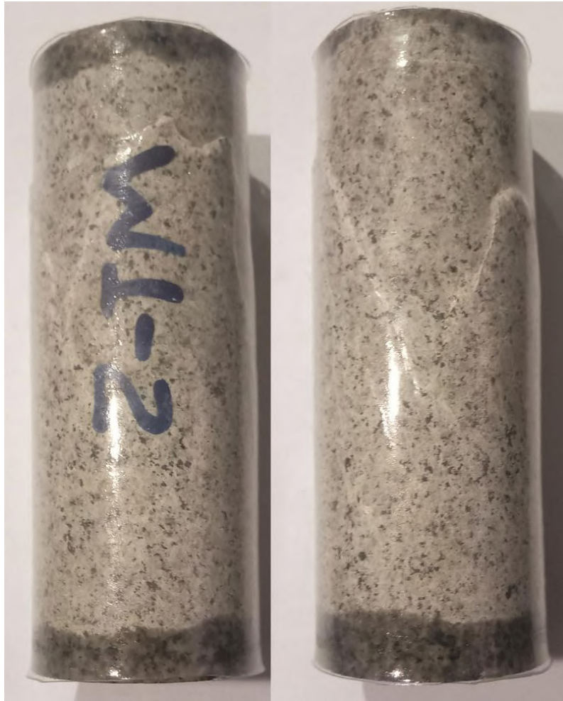
Figura 27: Lado A - Rompimento do W1-2 na tensão confinante de 10 MPa e tensão desviadora de 486,24 MPa.
