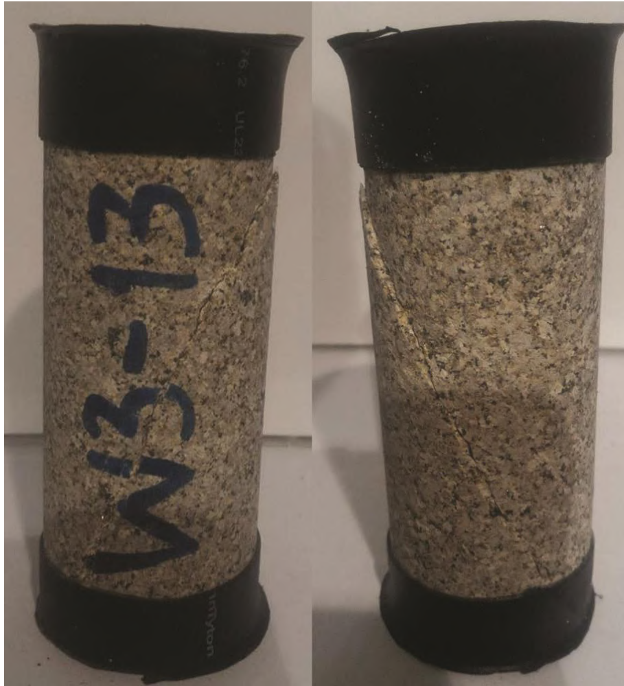
Figura 38: Rompimento do W3-13 na tensão confinante de 10 MPa e tensão desviadora de 183,93 MPa.
