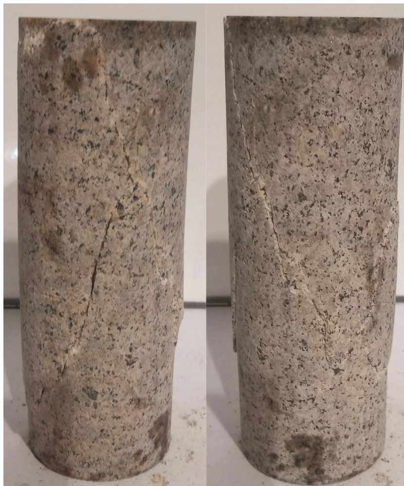
Figura 34: Lado B - Rompimento do W2-9 na tensão confinante de 10 MPa e tensão desviadora de 388,08 MPa.
