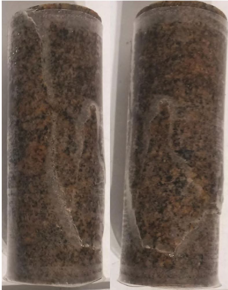
Figura 32: Lado B - Rompimento do W2-8 na tensão confinante de 5 MPa e tensão desviadora de 263,52 MPa.
