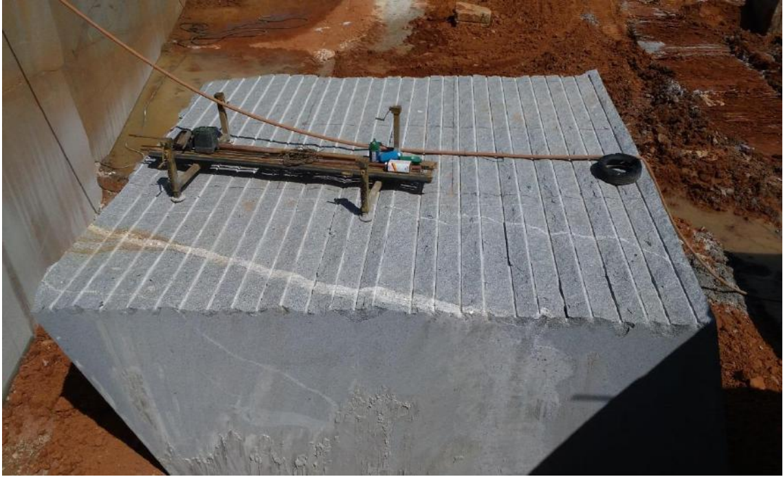
Figura 15: Bloco sendo cortado para rocha ornamental. Injeções aplíticas são comuns cortando o granito (MESQUITA, 2019).
