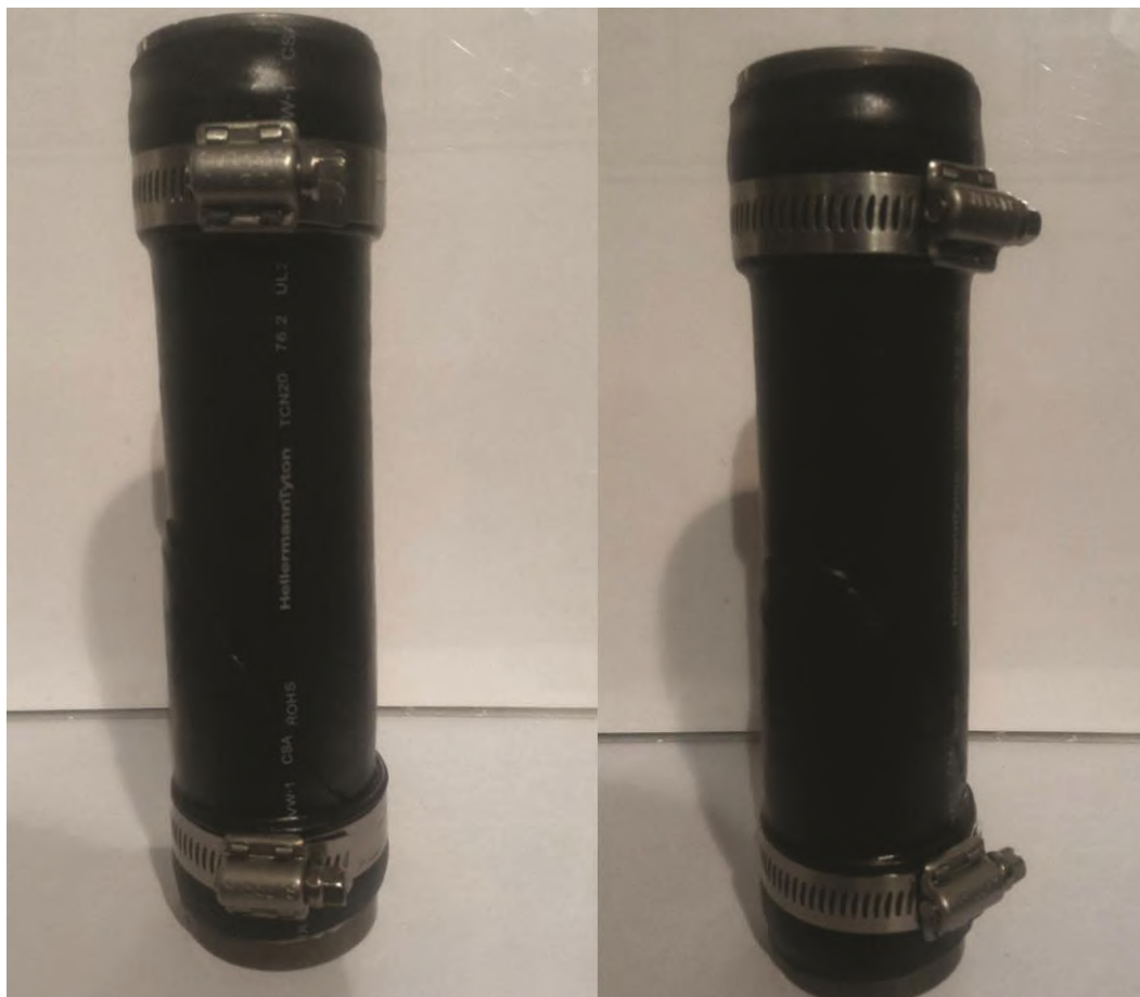
Figura 23: Corpo de prova envolto por uma membrana de borracha.
