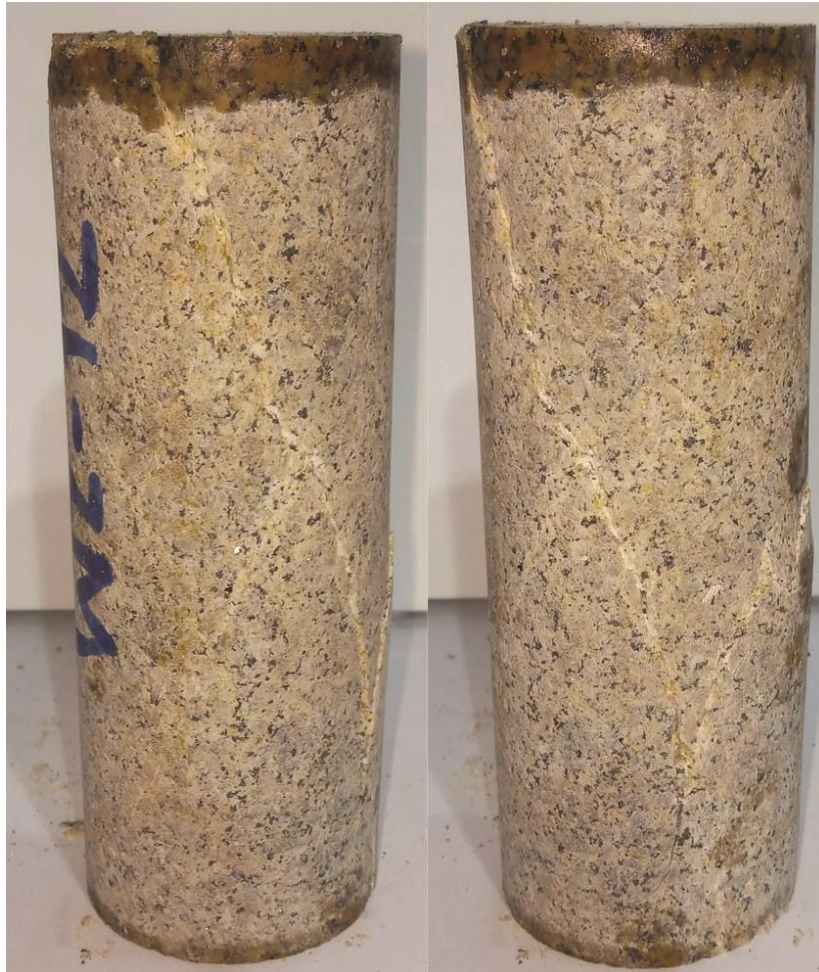
Figura 35: Rompimento do W2-12 na tensão confinante de 15 MPa e tensão desviadora de 484,38 MPa.
