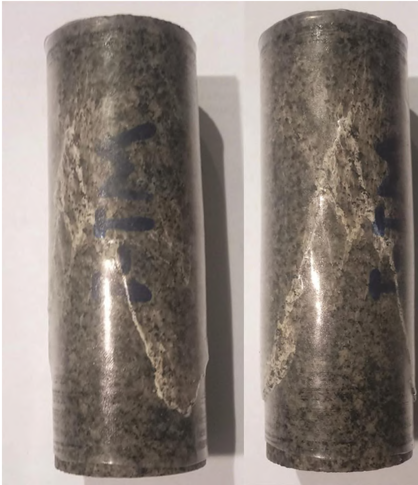
Figura 25: Lado A - Rompimento do W1-1 na tensão confinante de 5 MPa e tensão desviadora de 356,26 MPa.
