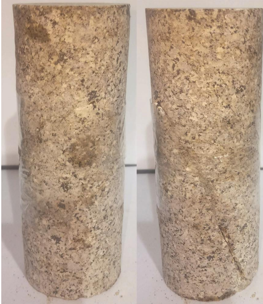
Figura 37: Lado B- Rompimento do W3-10 na tensão confinante de 5 MPa e tensão desviadora de 116,04 MPa.
