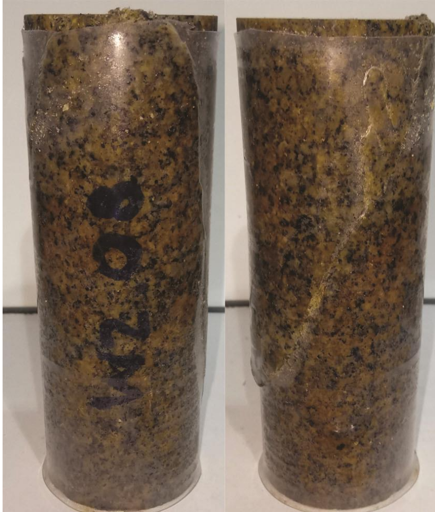
Figura 31: Lado A - Rompimento do W2-8 na tensão confinante de 5 MPa e tensão desviadora de 263,52 MPa.
